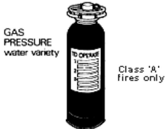
Gambar 14. Pemadam kebakaran yang berisi air
