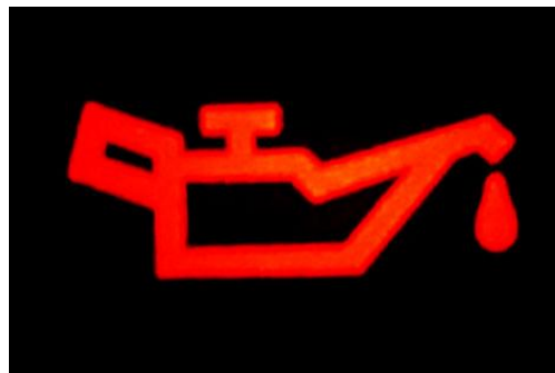
Gambar 20. Indikator sirkulasi oli pelumas
