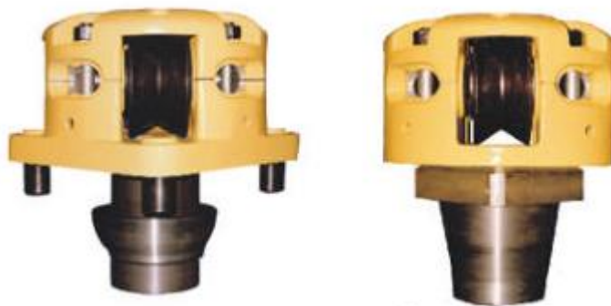
Gambar 4.17. Pin Drive (kiri) dan Square Drive (kanan)
