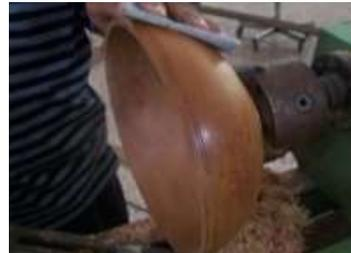
Gambar 4-27. Menghaluskan permukaan benda kerja.
