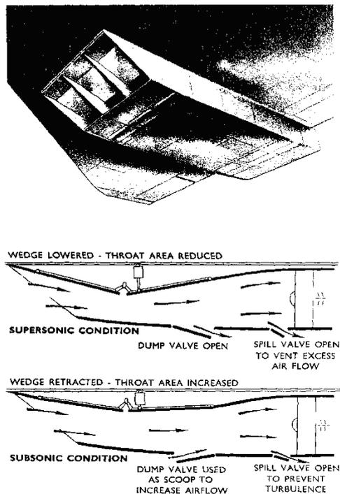
Gambar 23. Variable air intake untuk transonic.
