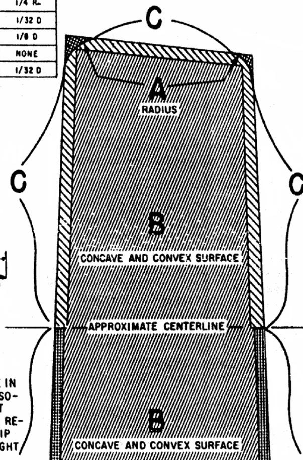
Gambar 33. Batasan wilayah perbaikan pada kompresor.
