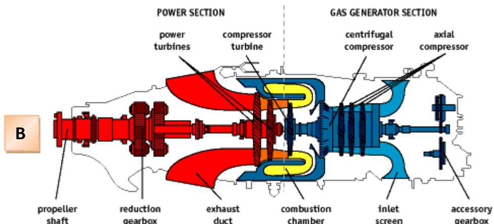
**Gambar 1: A dan B free turbine dalam turbopropeller**
