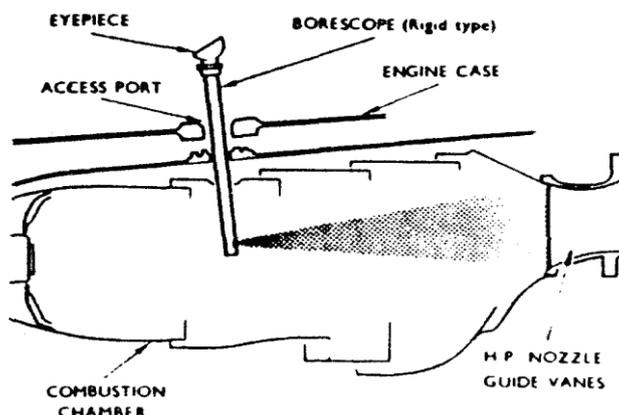
Gambar 38 Pemeriksaan terhadap H.P. nozzle guide vane Fuel nozzle dan pendukung.
