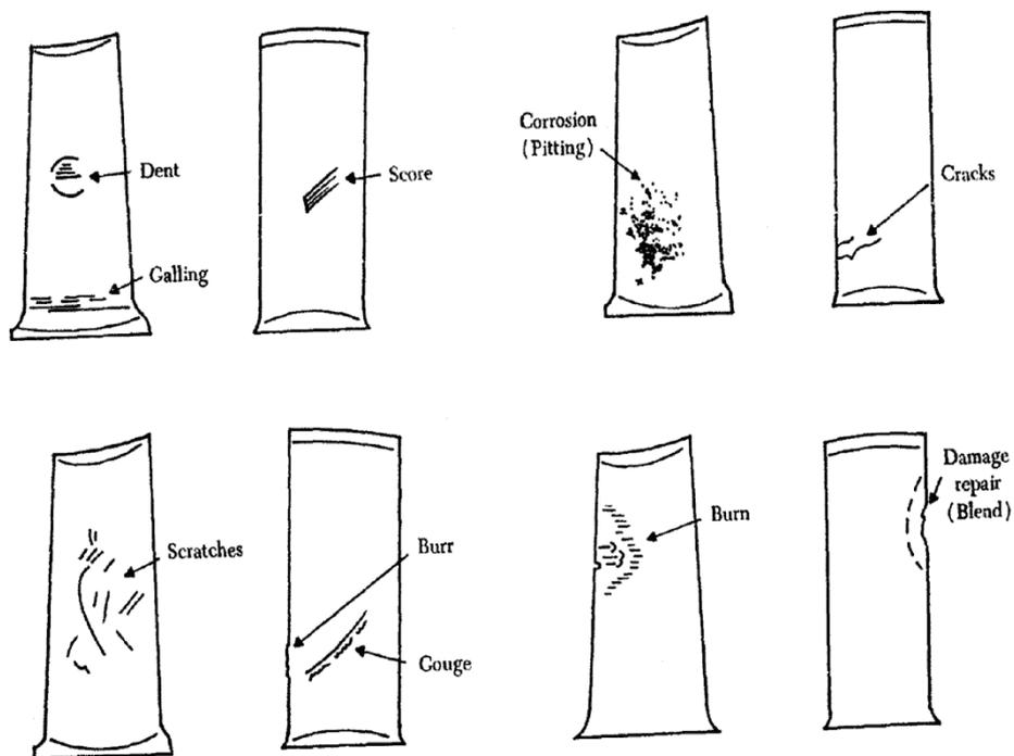
Gambar 35. contoh kerusakan pada axial kompresor blade
