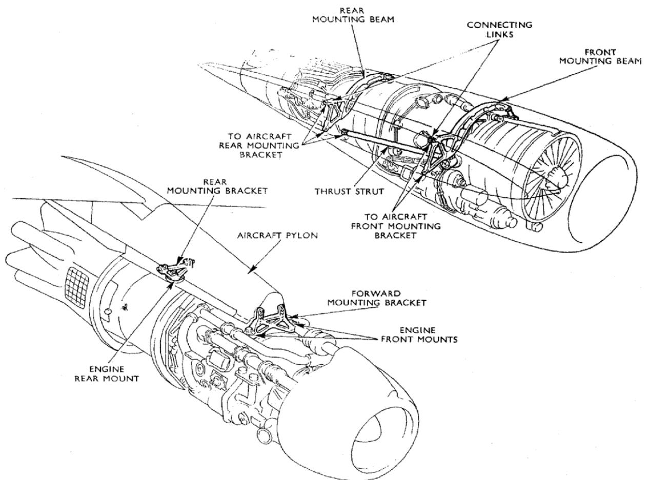
Gambar 27.udukan pengikatan engine.
