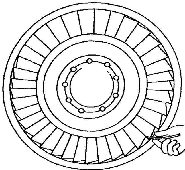
Gambar 43: Pengukuran kelonggaran pada ujung blade turbin
