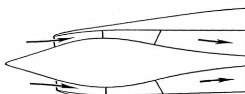
Gambar 22. Convergent-Divergent air intake untuk supersonic
