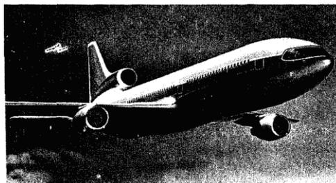
Gambar 19. Pemasangan motor pada bagian depan vertikal stabilizer dengan bawah sayap.
