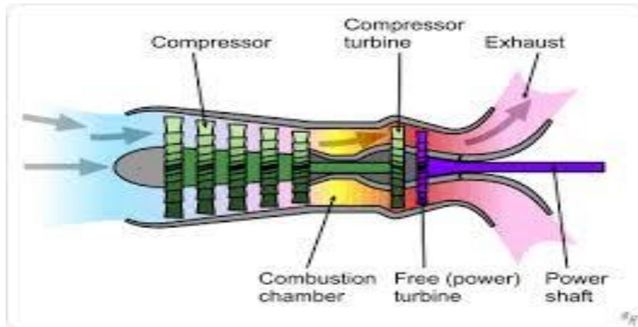
**Gambar 2: free turbine dalam turboshaft**
