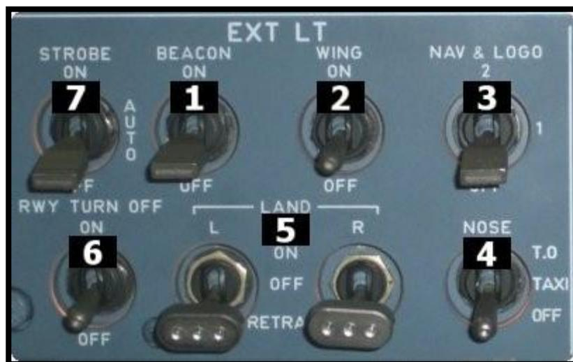
**Gambar 7.7 (Selektor Kontrol Lampu Pendaratan)**
