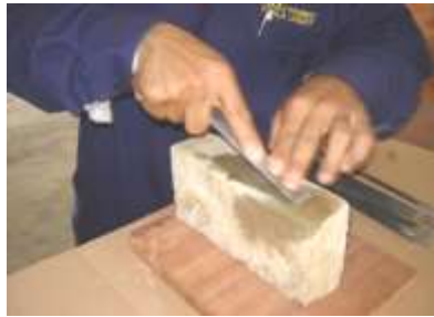
Gambar 2-12. Cara mengasah pahat penyilat /lurus bagian dalam mata pahat.
