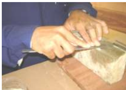
Gambar 2-13. Cara mengasah pahat penyilat/lurus bagian luar.
