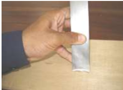
Gambar 1-20. Posisi tangan pada saat menggunakan pahat lengkung/penguku. Sumber: Buku Kriya Kayu SMK, Enget dkk
