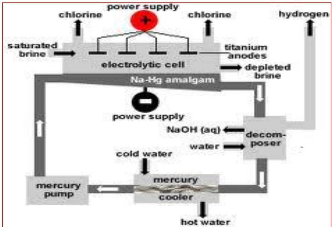
**Gambar 31. Sel elektrolisa dari larutan garam menghasilkan Cl<sub>2</sub>, H<sub>2</sub> dan NaOH**
