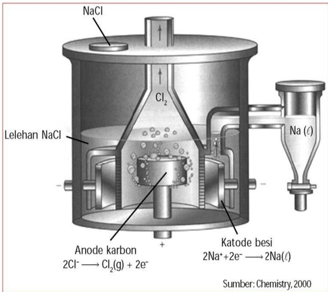
**Gambar 33. Sel elektrolisa untuk menghasilkan gas chlorine.**
