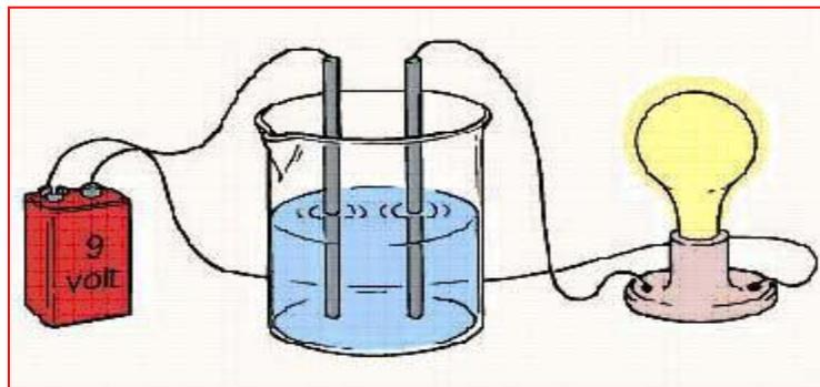
**Gambar 6. Rangkaian untuk uji sifat daya hantar larutan.**
