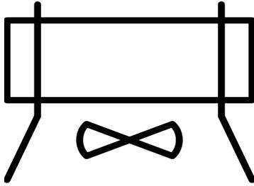
Simbol .79. Ali blow cooler atau pendingin aliran udara.
