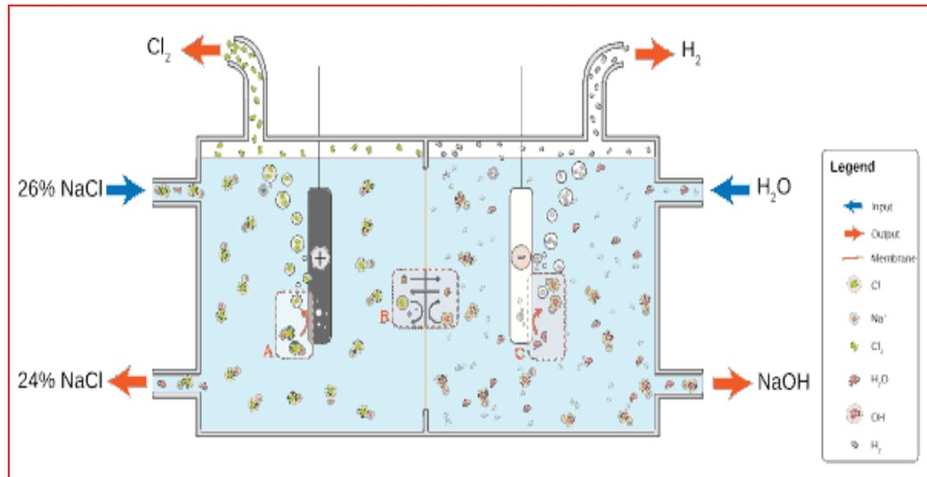
**Gambar 34. Membran Sell Untuk Mendapatkan Gas Chlorine, Gas H<sub>2</sub> Dan Larutan NaOH**
