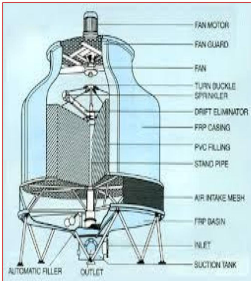
**Gambar 23. Bentuk Fisik Dari Cooling Tower Portabel.**
