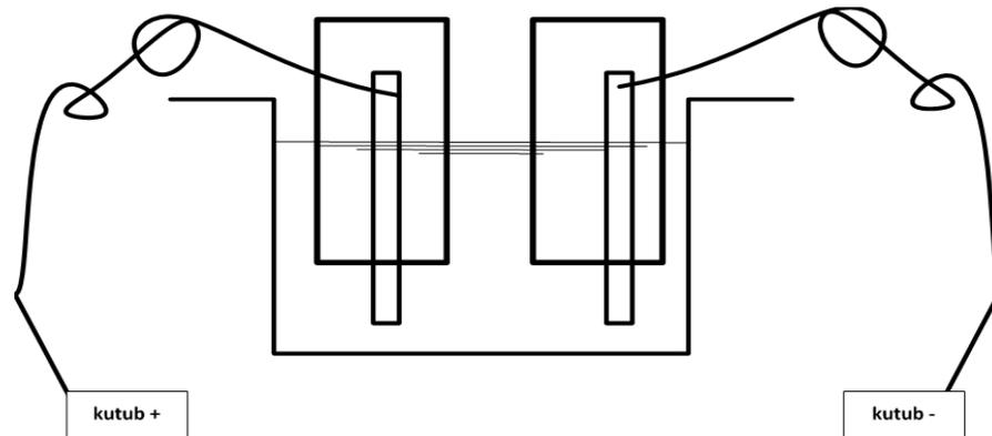
Lakukanlah larutan garam diatas setelah disaring dari kotoran yang terikut buatlah rangkaian seperti diatas dengan sumber arus menggunakan baterai 3 volt, check kondisi larutan garam setiap 5 menit. Lakukalah secara terus menerus sehingga larutan menjadi basa.
