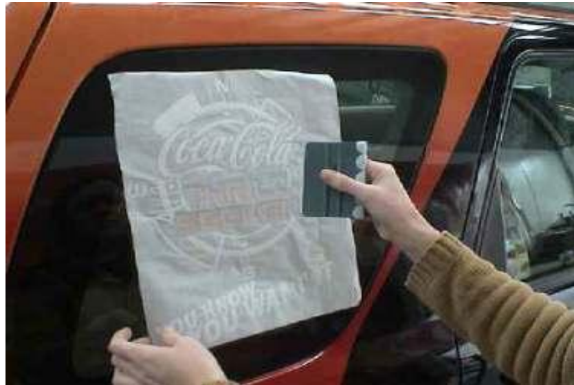
Gb.2.61. Penempelan decal pada permukaan kaca kendaraan
