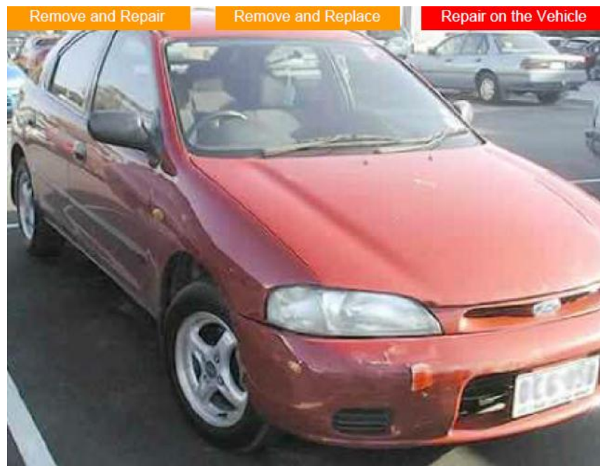
Gb.2.15. Pelindung (guard) yang rusak akan diperbaiki tanpa melepas pelindung (guard) dari bodi kendaraan
