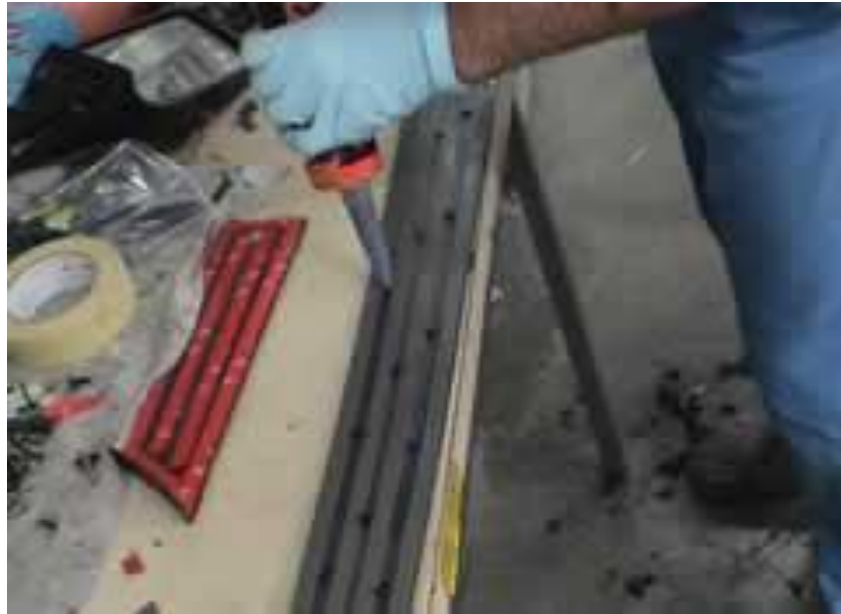
Gb.2.39. Pemberian perekat tambahan berupa lem polyurethane untuk menambah kekuatan daya rekat moulding terhadap panel bodi kendaraan
