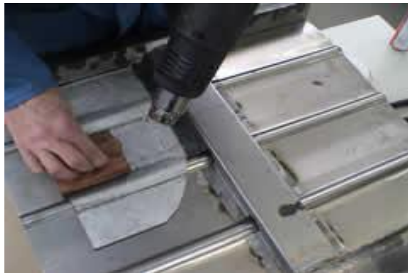
Gb.4.26. Pemanasan permukaan menggunakan heat gun
