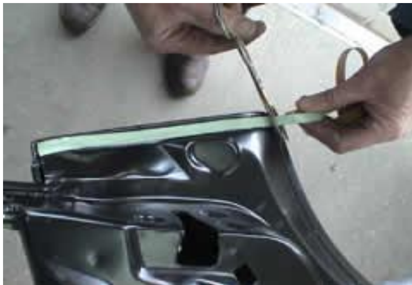
Gb.4.6. Pemotongan pita perekat
