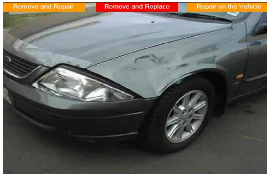
Gb.1.6. Pelindung (guard) yang mengalami kerusakan
