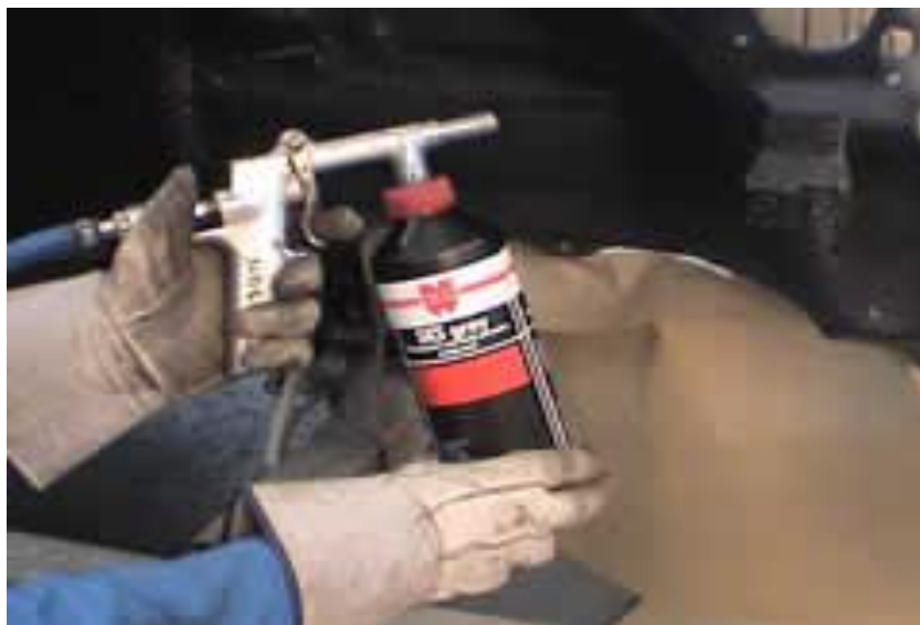
Gb.4.38. Anti-chipping paint diaplikasikan menggunakan sprayer udara
