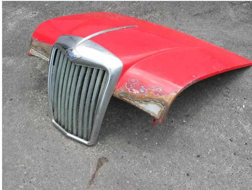
Gb.1.5 Grill dan kap mesin (bonnet) dalam kondisi perbaikan
