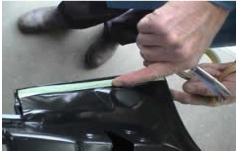
Gb.4.5. Penekanan pita perekat dengan menggunakan jari tangan
