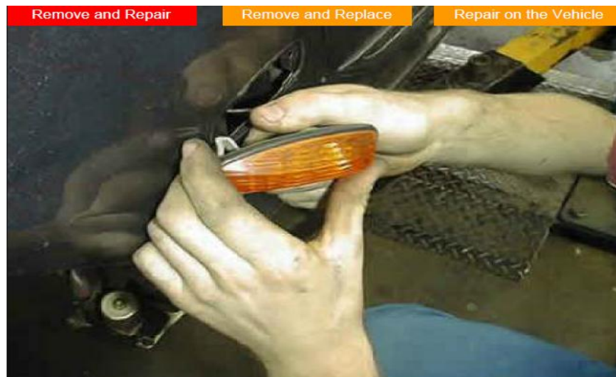
Gb.1.14. Pelepasan lampu-lampu dan kelistrikan bodi
