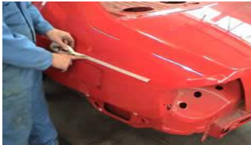
Gb.2.50. Pemberian tanda pada panel bodi kendaraan tempat decal akan dipasang dengan menggunakan masking tape
