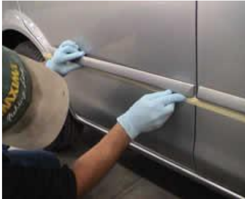
Gb.2.40. Pemasangan moulding dengan berpedoman pada garis masking tape yang sudah terpasang sebelumnya.
