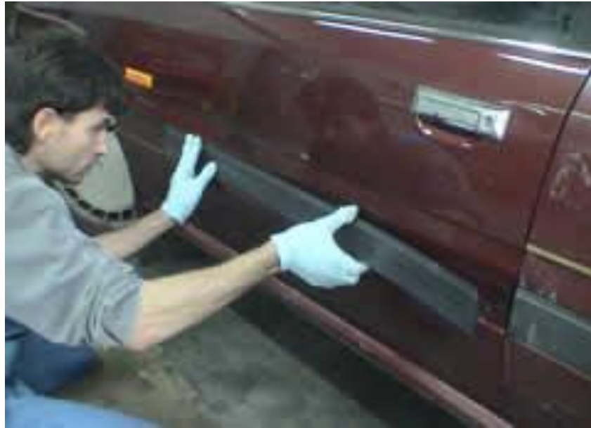
Gb.2.41. Pemasangan moulding juga dapat berpedoman pada kontur memanjang dari bodi kendaraan
