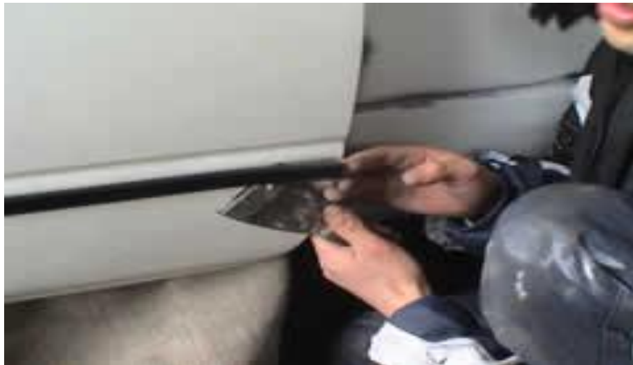
Gb.1.30. Penggunaan kapi/skrap untuk mengungkit moulding
