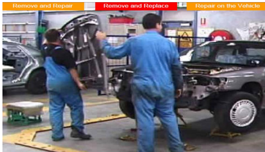
Gb.1.12. Pelepasan bonnet (kap mesin)
