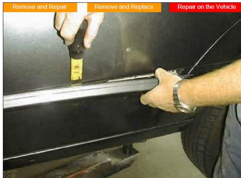
Gb.2.20. Pelepasan moulding
