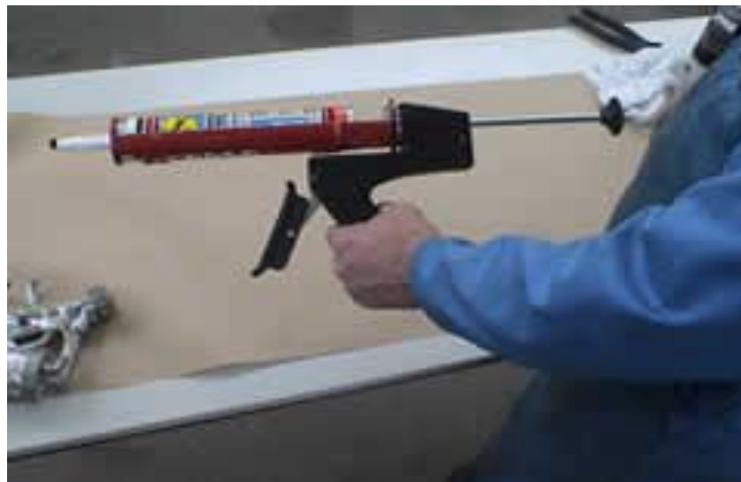
Gb.4.12. Penempatan cartridge/botol berisi sealer pada caulking gun
