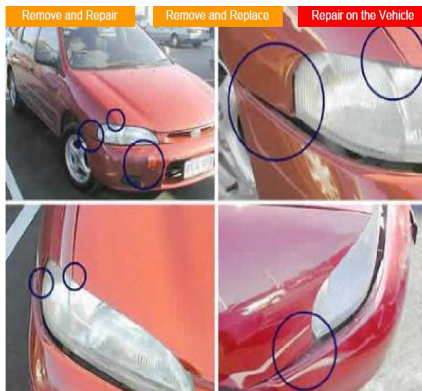
Gb.2.16. Pemeriksaan kerusakan pada pelindung (guard).
