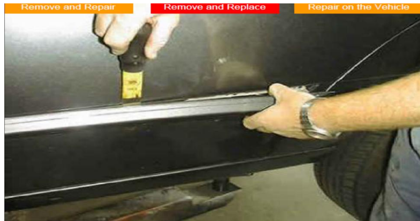
Gb.1.15. Pelepasan moulding
