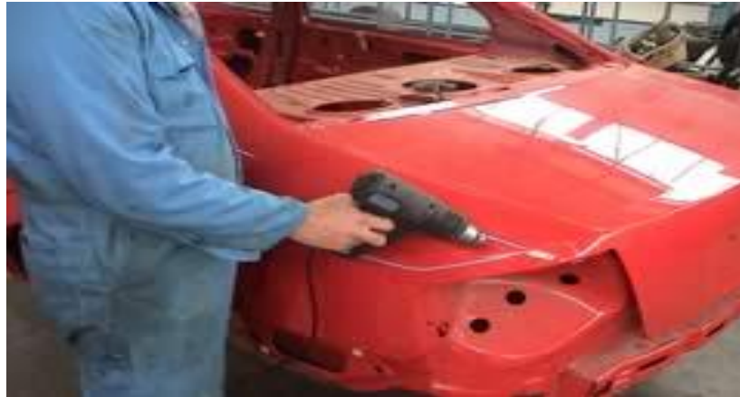
Gb.1.52. Pemanasan pinstrip dengan menggunakan heat gun
