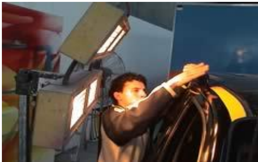
Gb.1.49. Pemanasan permukaan wrap menggunakan panel lampu infrared
