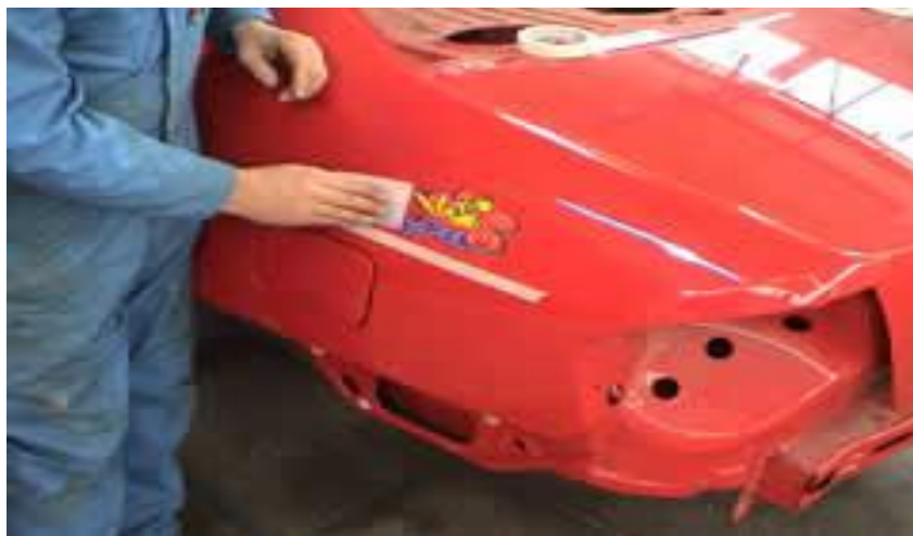
Gb.2.52. Pemberikan tekanan pada permukaan decal menggunakan squeegee lunak
