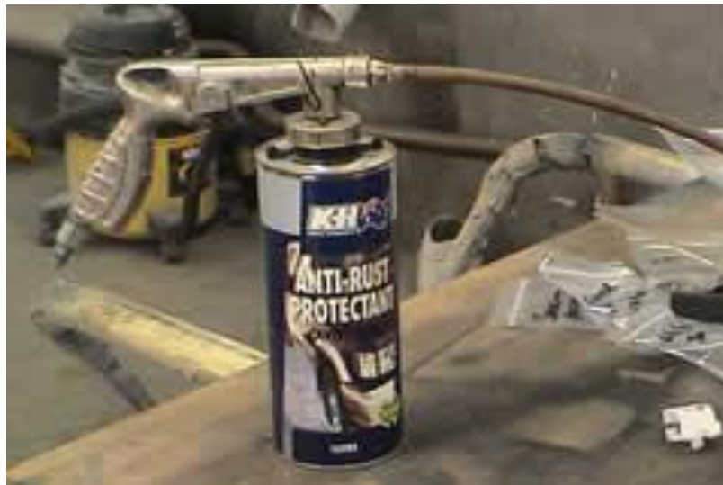
Gb.4.34. Cavity wax diaplikasikan menggunakan sprayer udara
