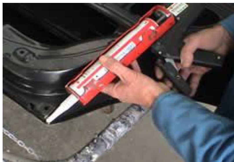
Gb.4.14. Pelapisan sealer sepanjang bidang pengelasan
