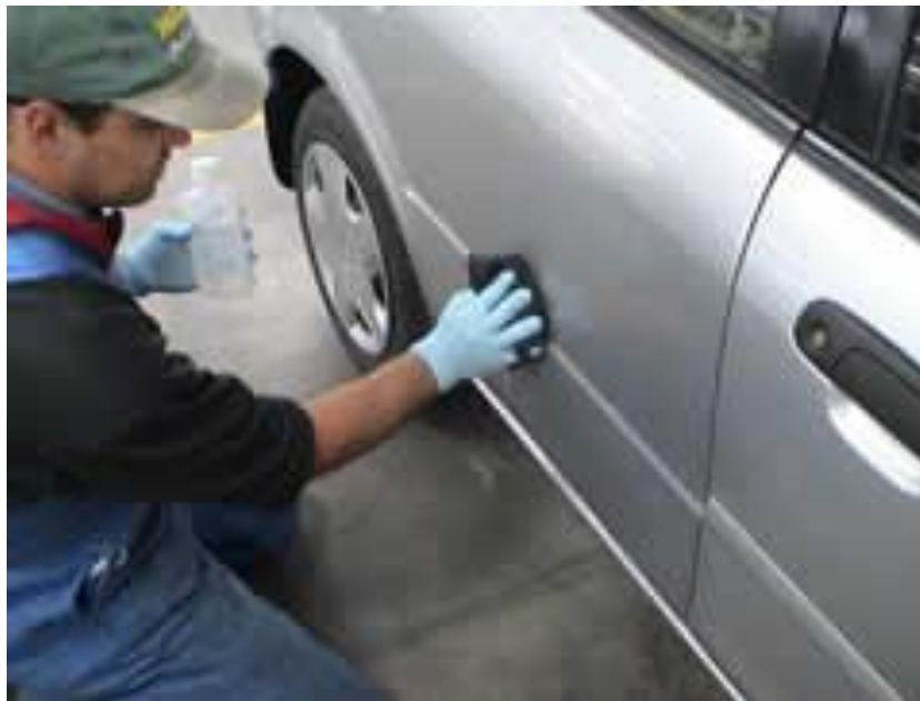
Gb.2.35. Pembersihan panel bodi kendaraan dari jenis kotoran, kerak atau minyak
