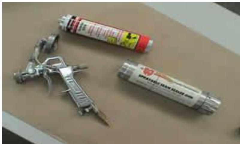
Gb.4.46. spray-on sealant diaplikasikan menggunakan sprayer udara
