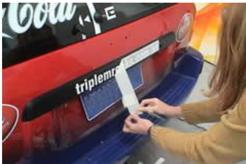
2.57. Pelepasan kertas transfer secara hati-hati
