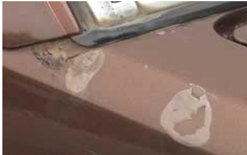
Gb.3.2. Awal terjadinya korosi, cat pada bodi kendaraan menjadi terkelupas serta mulai terbentuk kerak
