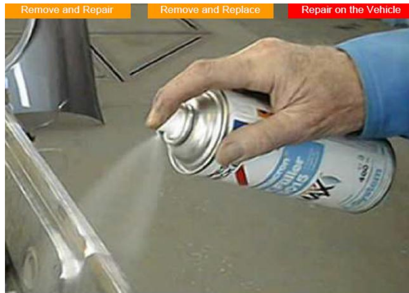
Gb.2.22. Pekerjaan aplikasi cat primer dan sealer serta cat finishing
