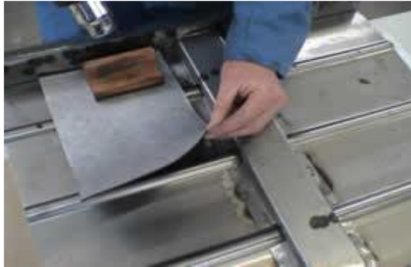
Gb.4.25. Pemasangan lembaran peredam suara
