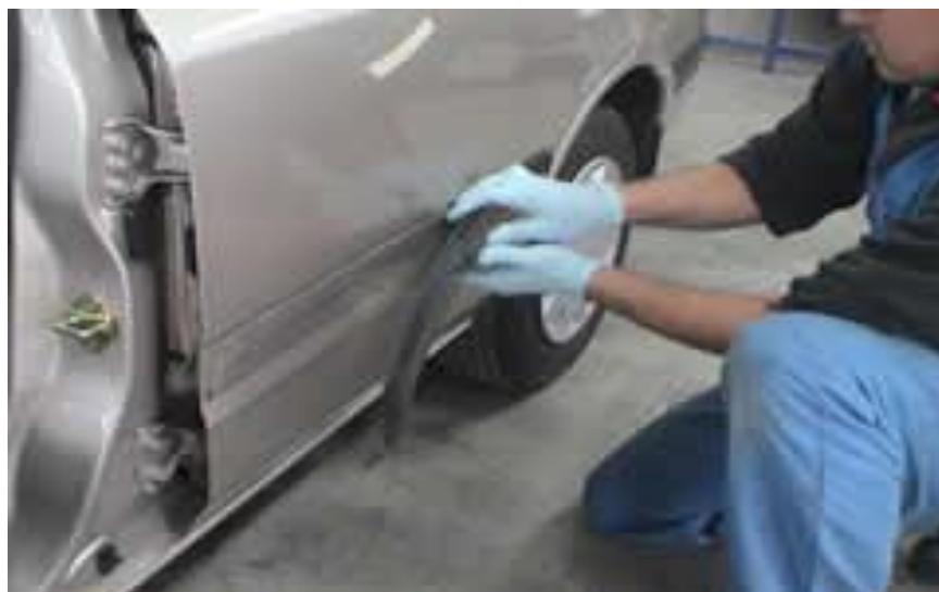
Gb.1.36. Pekerjaan mengungkit dilakukan sampai seluruh moulding terlepas dari panel kendaraan
