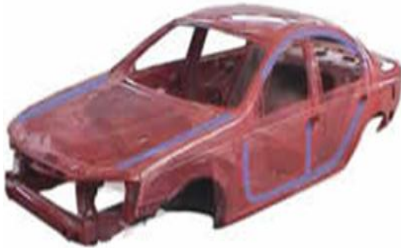
Gb.4.2. Daerah pemasangan seam sealer tape (berwarna biru)
