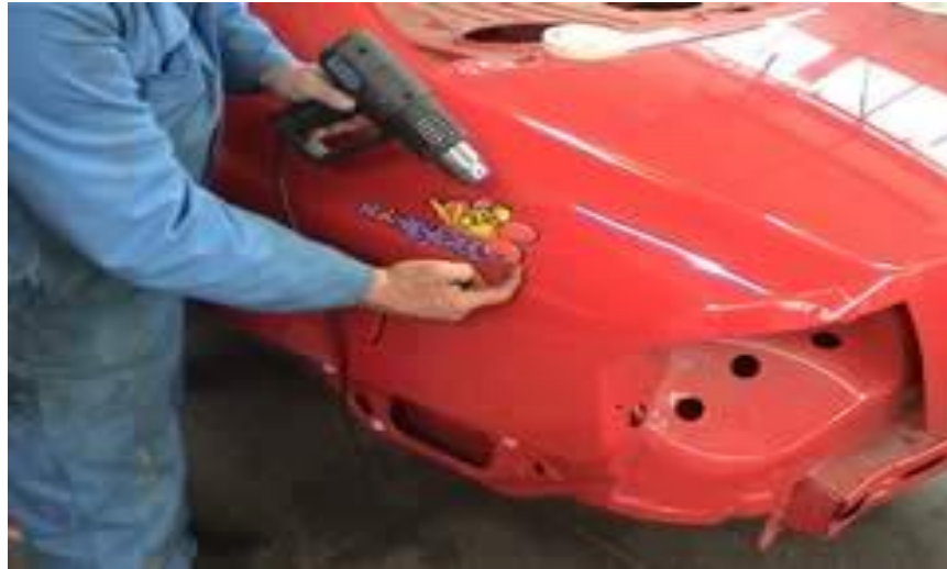
Gb.1.44. Pengangkatan salah satu ujung/tepi decal dengan menggunakan kuku jari
