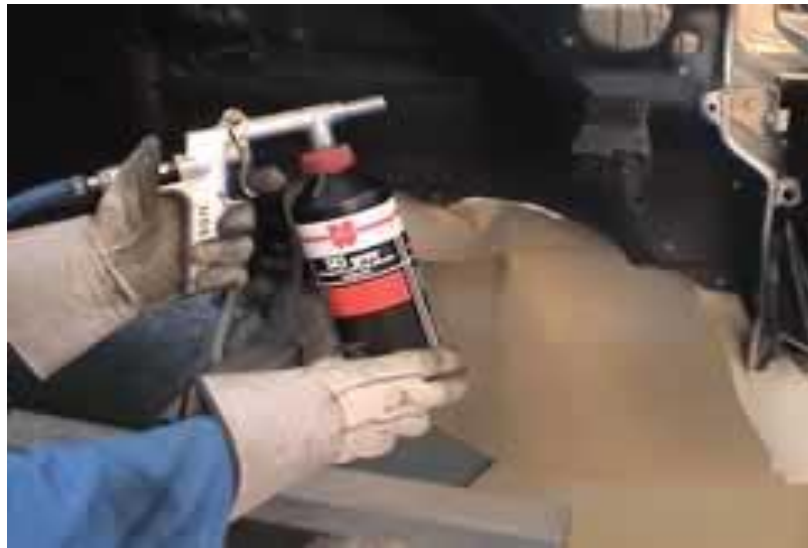
Gb.3.5. Pelapisan anti karat pada bagian bawah lantai kendaraan
