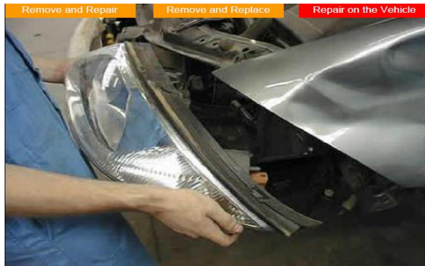
Gb.2.18. Pelepasan bagian kendaraan yang dekat dengan bagian yang akan diperbaiki
