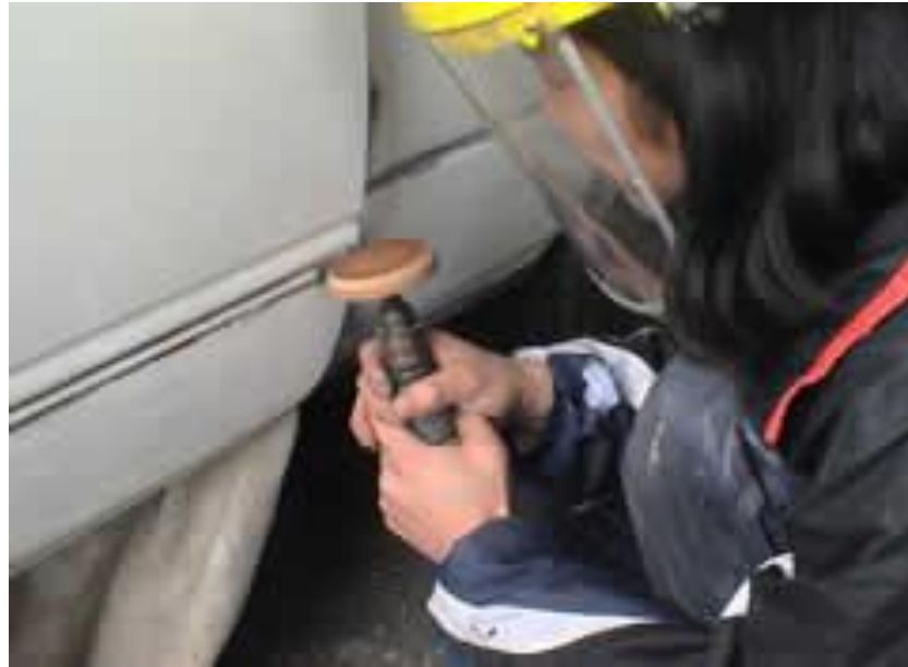
Gb.2.36. Penggunaan alat rubber wheel untuk membersihkan sisa sisa lem yang masih sulit untuk dibersihkan
