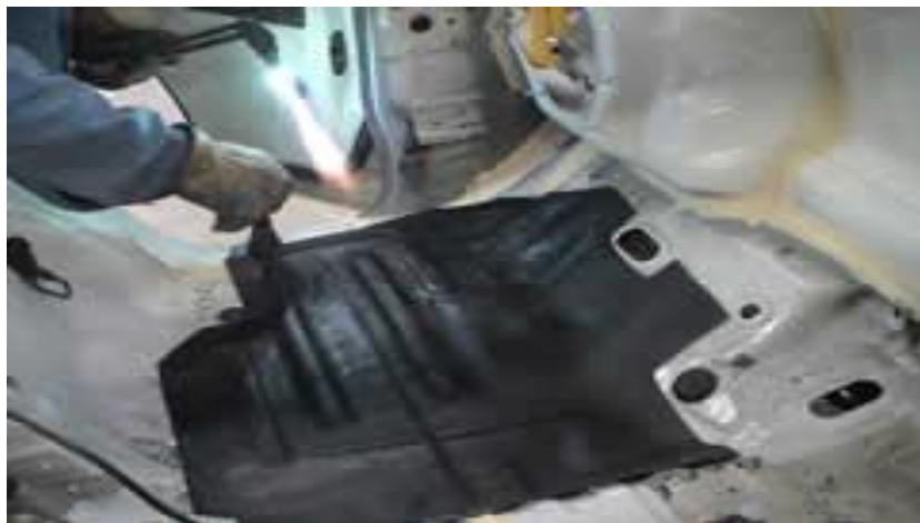
Gb.4.31. Pemotongan tepian/ujung material peredam suara
