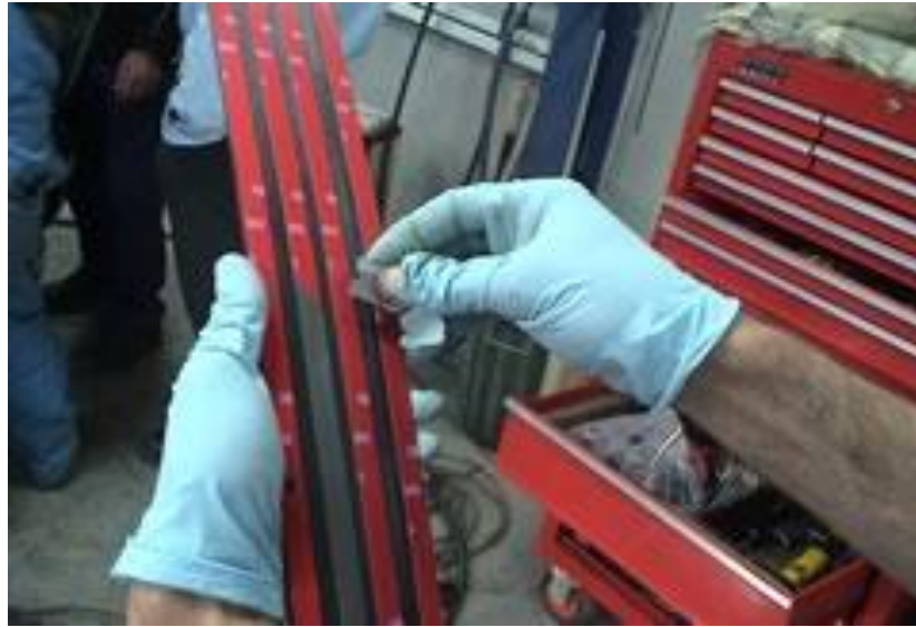
Gb.2.38. Pelepasan lembar pelindung lapisan lem dari pita perekat dua sisi (double sided)
