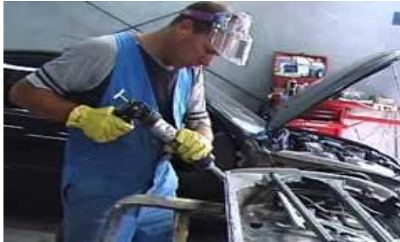
Gb.3.6. Pemberian perapat/sealer pada join dan seam pengelasan
