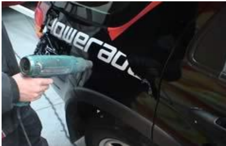
Gb.1.48. Pemanasan permukaan wrap menggunakan heat gun
