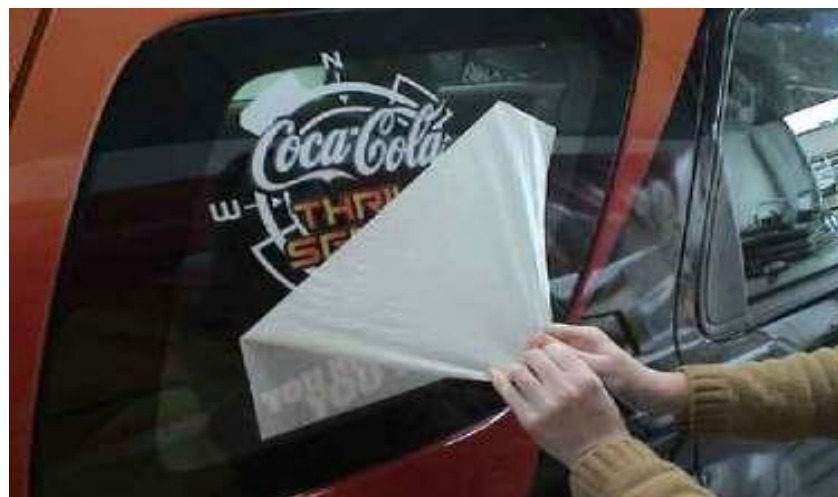
Gb.2.62. Pelepasan kertas transfer dari permukaan decal
