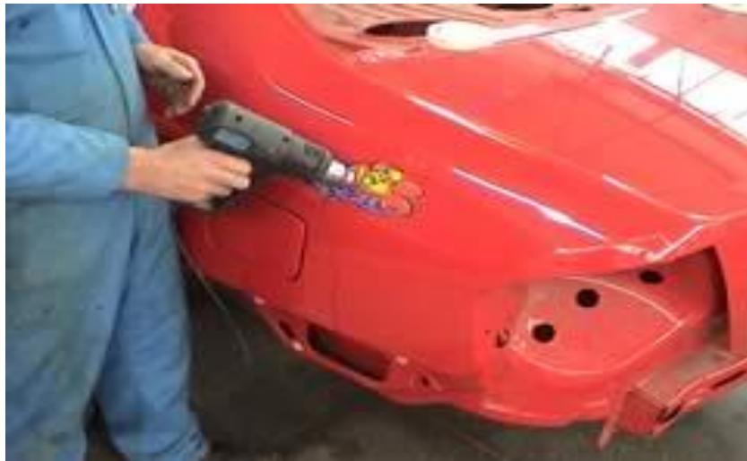
Gb.1.43. Pemanasan permukaan decal dengan menggunakan heat gun
