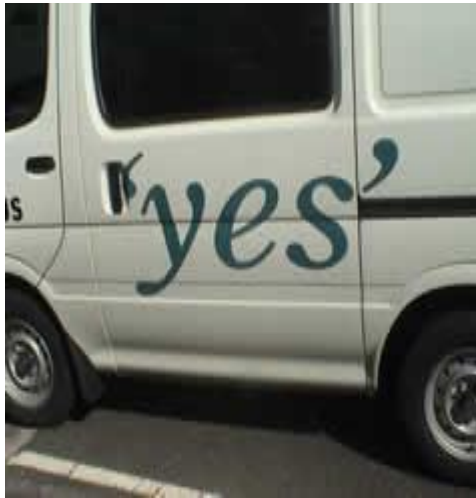
Gb.2.44. Decal dicetak pada lapisan vinyl berperekat
