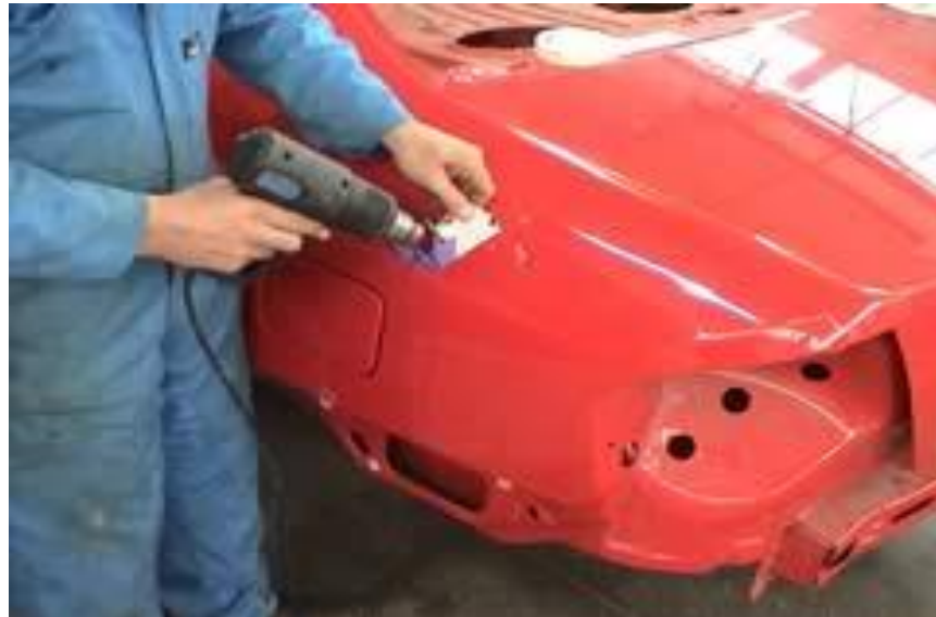
Gb.1.45. Pelepasan decal dari bodi kendaraan
