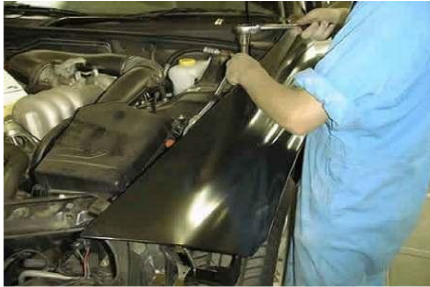
Gb.2.14. Pemasangan kembali pelindung (guard) yang baru
