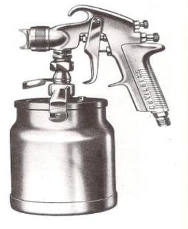
Apabila pelatuk (Trigger) ditarik kebelakang maka katup udara akan terbuka sehingga udara masuk ke spray gun. Bersamaan dengan itu jarum cairan (fluid needle) akan terbuka. Udara melalui lubang kecil pada fluid tip kecepatannya akan bertambah.
