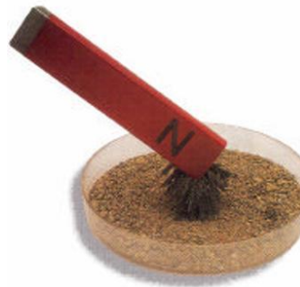
Gambar 6.1 Magnet batang menarik serbuk besi
