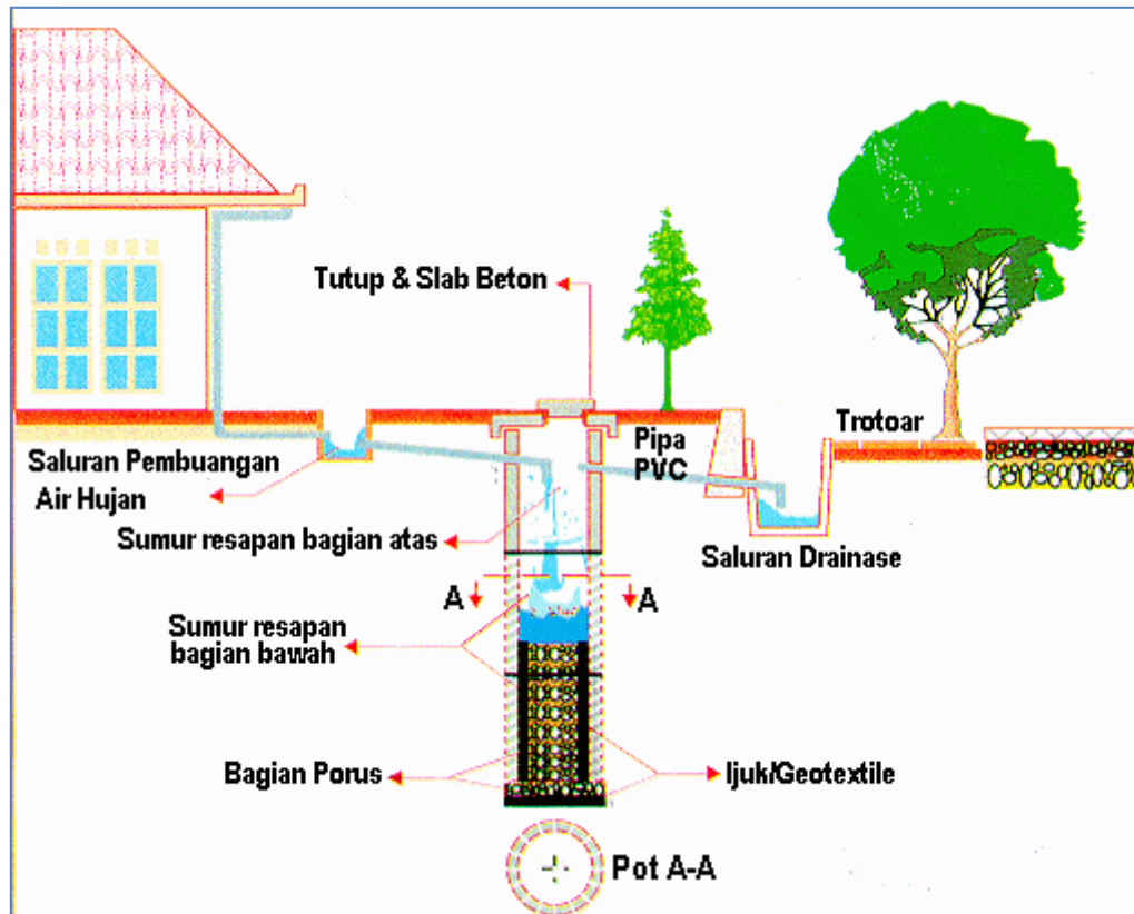
Gambar 44. Penampang membujur sumur resapan Biopori
