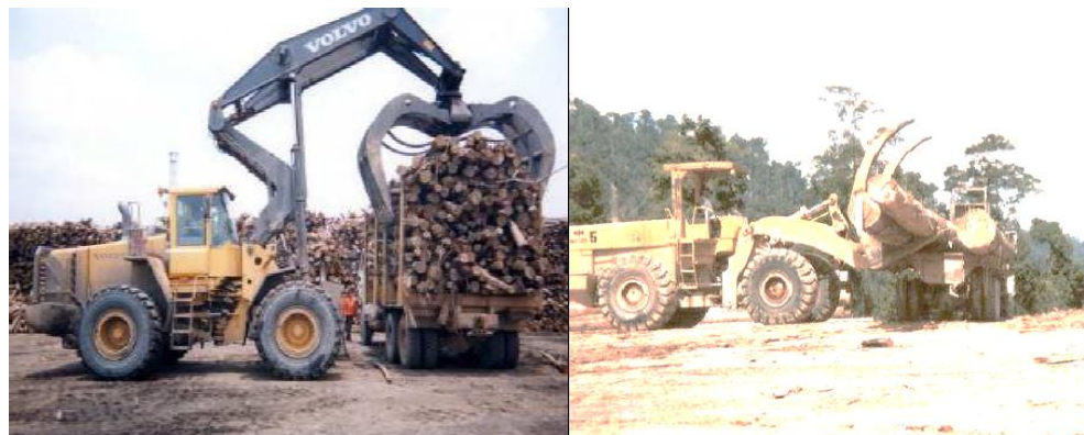
Gambar 90. Pemuatan/Pembongkaran Dengan Wheel Loader
