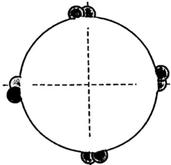
Prinsip yang sama juga dapat digunakan pada pengelasan kampuh V atau U ganda. Pengelasan dilakukan dengan sisi atau permukaan yang berlawanan. Konstraksi akan terjadi sama pada kedua belah permukaan. Untuk langkah pengelasan dapat diperhatikan gambar berikut.
