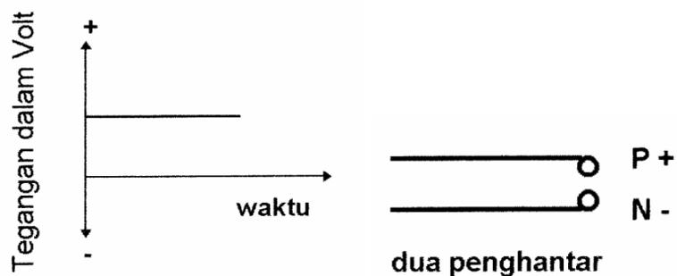
Pada arus searah electron bergerak dalam lingkaran arus pada arah searah dan kutub negative ke kutub positif.
