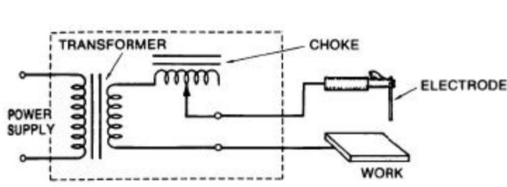
Mesin las AC memperoleh busur nyala dari transformator, dimana dalam pesawat ini jaring-jaring listrik dirobah menjadi arus bolak-balik oleh transformator yang sesuai dengan arus yang digunakan dalam pengelasan, pada mesin ini kabel las dapat dipertukarkan pemasangannya dan tidak mempengaruhi perubahan temperatur pada busur nyala. 50% panas disalurkan ke elektroda dan 50% disalurkan ke base metal.
