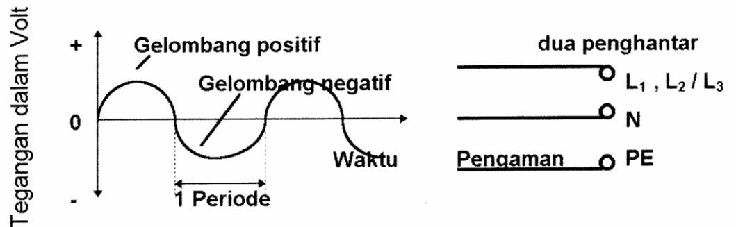
Arah gerakan electron-elektro dalam lingkaran arus searah adalah berubah-ubah secara periodic yang tetap. Dalam satu detik terjadi seratus kali putaran antara kutub positif dan kutub negative atau 50 periode (50 Hertz). Dengan demikian tegangan berubah menurut kurva sinus. Tegangan naik dari nilai nol ke nilai puncak kurva, turun kembali ke nol dan naik lagi tetapi dengan polaritas yang berlawanan (terbalik).
