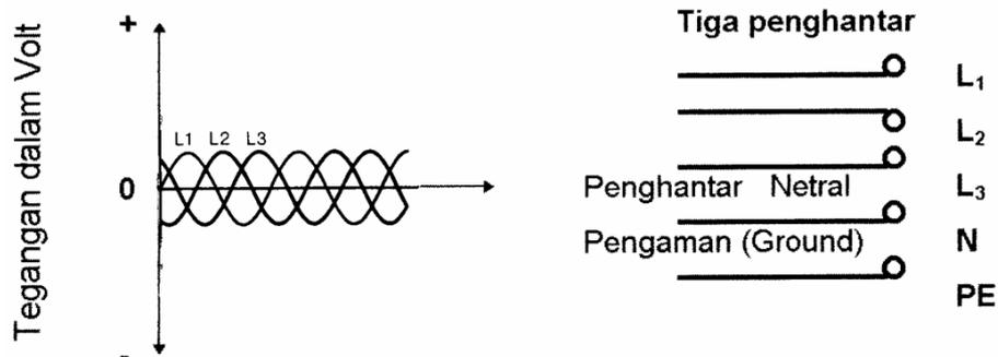
Arus bolak-balik tiga phase merupakan susunan dari tiga arus bolak-balik dengan frekuensi 50 Hz, sehingga penampang penghantarnya menjadi lebih kecil. Arus bolak-balik tiga phase umumnya digunakan untuk peralatan dengan kebutuhan arus yang besar dengan tegangan 380 Volt.
