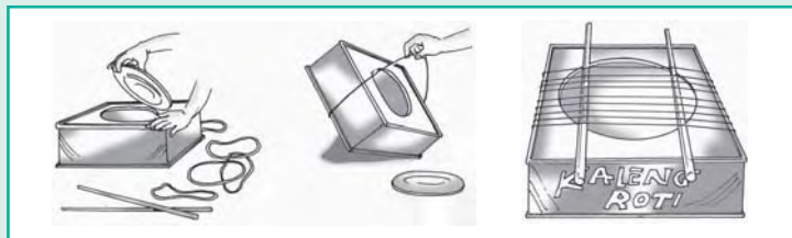
Gambar 12.2 Cara membuat gitar sederhana
