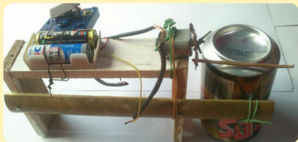
Sumber: Dok. Kemdikbud Gambar 2.31. hasil akhir bel sederhana dengan arus listrik DC
