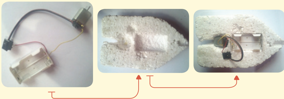
Sumber: Dok. Kemdikbud Gambar 2.47. Penggabungan rangkaian dengan body perahu
