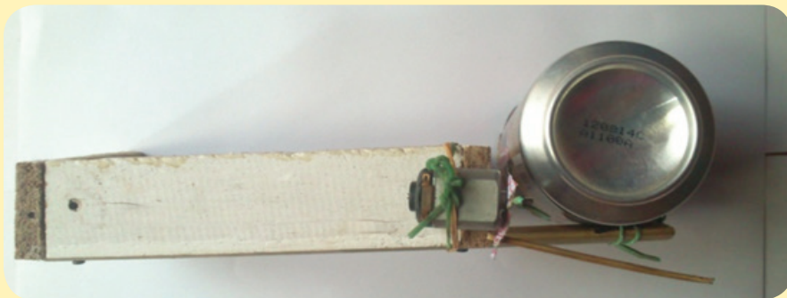
Gambar 2.27. Motor Listrik DC terpasang pada rangka
