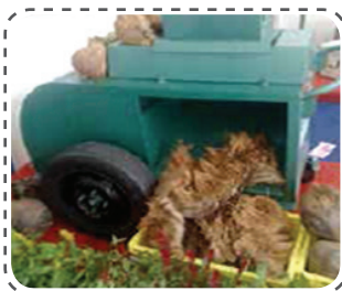
Mesin pemotong kelapa dan pengupas sabut kelapa
