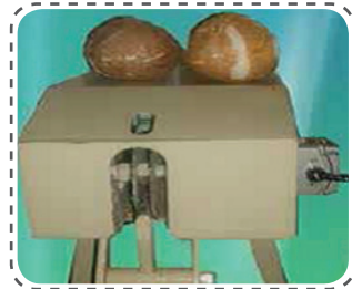
Mesin pengupas sabut dan mesin pemecah batok/tempurung kelapa
