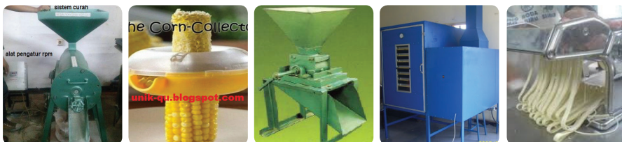
Gambar 4.48. Mesin untuk pengolahan serealialia dan umbi yaitu mesin sosoh, alat pemipil jagung, mesin penggiling, mesin pengering, dan alat penggiling mie.
