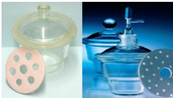
Gambar 18. Desikator dengan lempengan porselen dan Desikator yang dilengkapi dengan kran penghampaan
