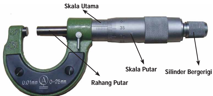
Gambar 1.17 Bagian-Bagian Mikrometer Sekrup Sumber Gambar: www.phy.uct.ac.za (2008)
