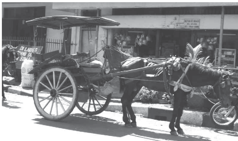
Gambar 5.11 Roda Pedati Dipasang dengan Prinsip Pemuaiian Foto: Dokumentasi Penerbit
