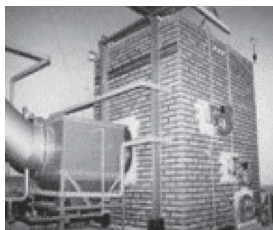
Gambar 14.23 Incenator, Alat untuk Membakar Sampah yang Tidak Dapat di Daur Ulang Sumber Gambar: Microsoft Encarta 2005
