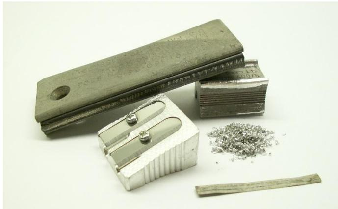
**Gambar 42. Produk yang terbuat dari magnesium : pemantik api, serutan pensil, dan pita magnesium (sumber : google.com)**
