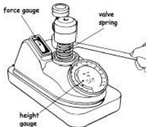
Gambar 3.158. Mengukur tekanan pegas katup
