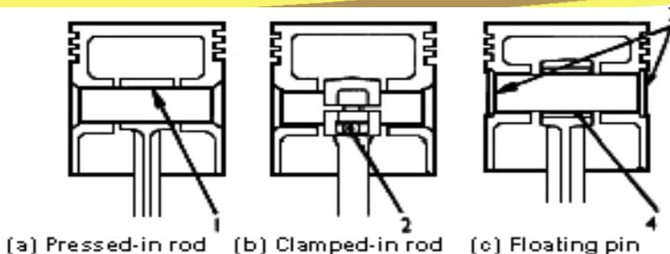
Gambar 3.88. Metoda pemasangan batang torak terhadap torak
