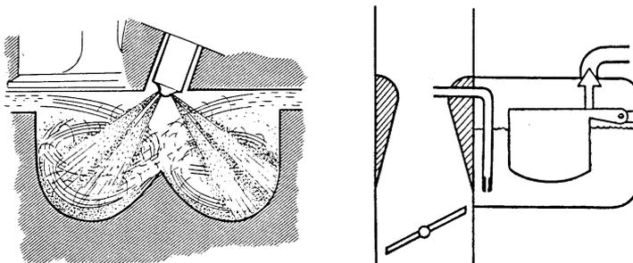
Gambar 3.5. Pembentukan campuran motor disel dan bensin
