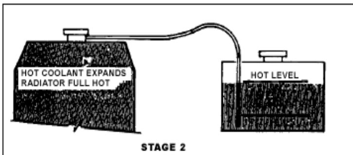
Gambar 2.70. Stage 2 pengisian air pendingin dengan reservoir
