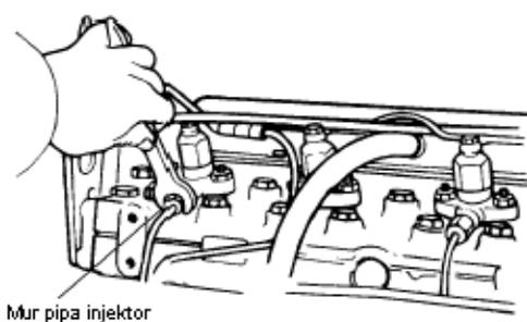
Gambar 3.193. Pengendoran Pipa Injektor Selama Pengetesan Penelusuran Injektor
