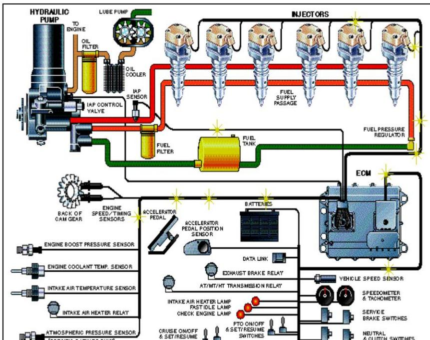
Gambar 2.58. Sistem Bahan bakar HEUI (*Engine 3126B*)
