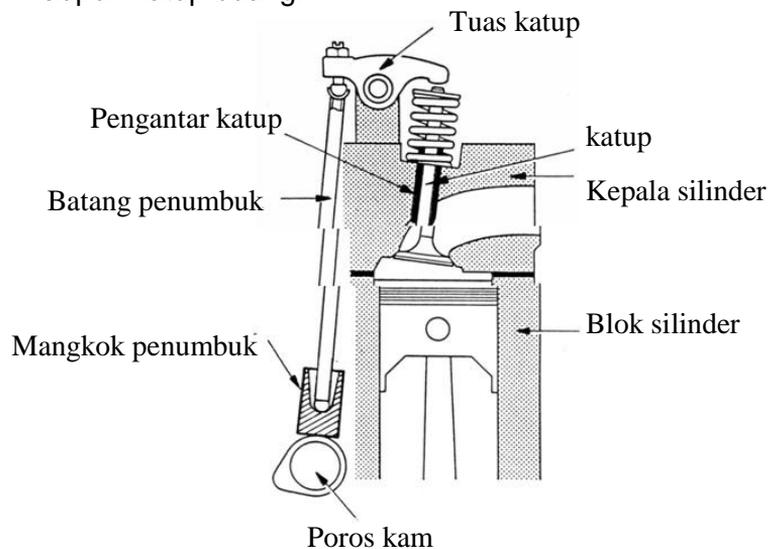
Gambar 3.207. Mekanisme Katup
