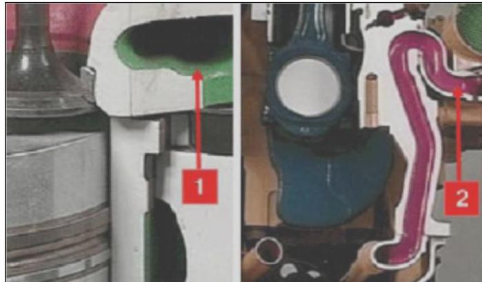
Gambar 3.57. Saluran air dan oli pada blok
