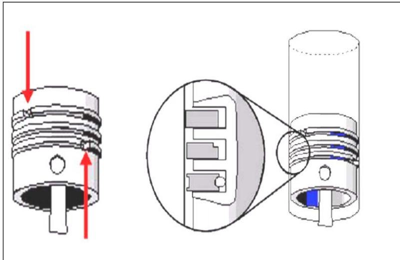
Gambar 3.80. Konstruksi *ring piston*
