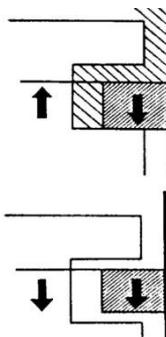
Gambar 3.202. Posisi cincin pada langkah kompresi dan usaha
