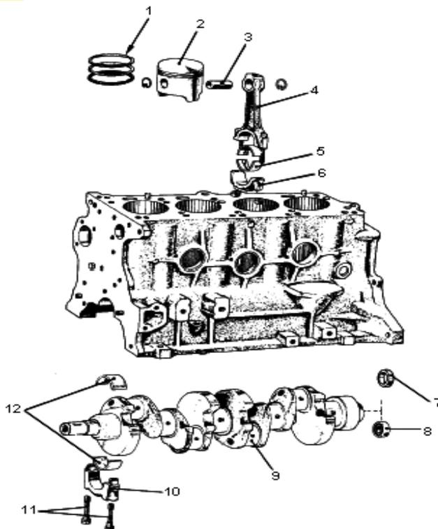
Gambar 3.51. Blok silinder grup
