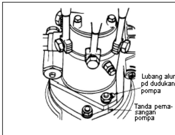
Gambar 3.198. Alur penyesuaian penyetelan pada dudukan pompa
