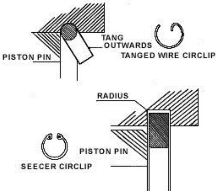
Gambar 3.70. Pemasangan circlip
