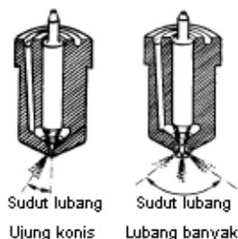
Gambar 3.196. Bentuk Semprotan Konis Nosel Injektor Ketika Terbuka
