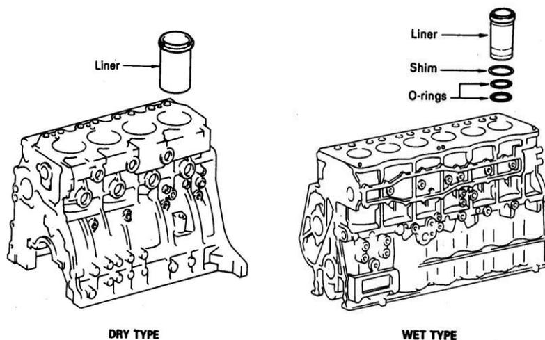
Gambar 3.50. Tabung silinder tipe kering dan basah
