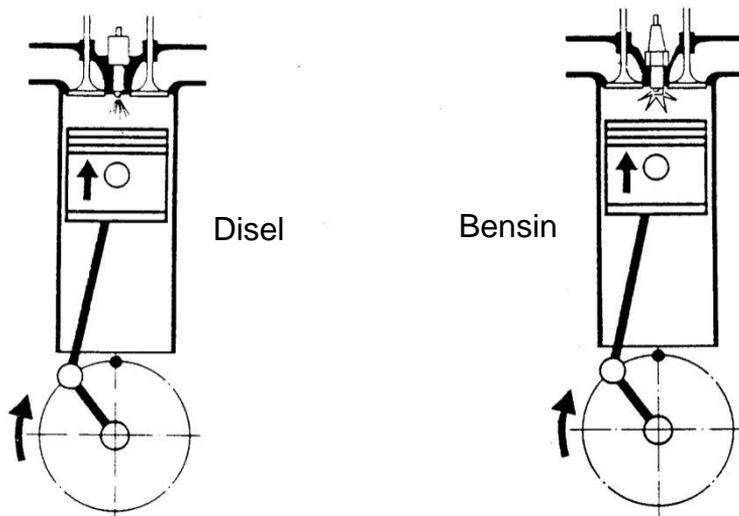
Gambar 3.40. Mesin disel dan bensin
