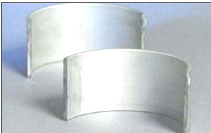
Gambar 3.92. *Bearing* batang torak
