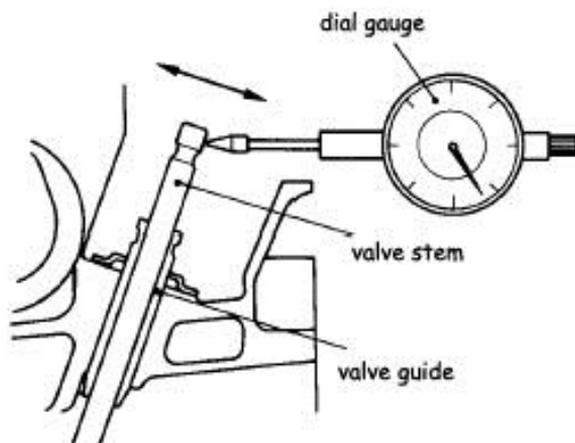
Gambar 3.138. DTI pada ujung batang katup
