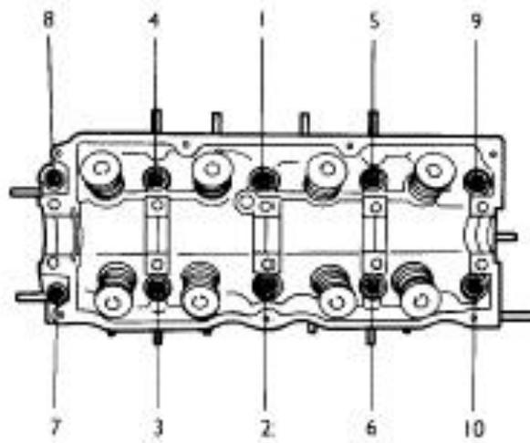
Gambar 3.161. Formasi pengencangan baut cylinder head
