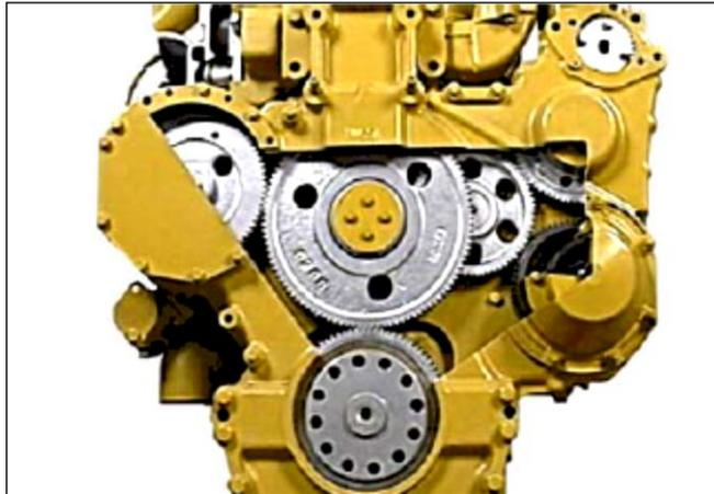
Gambar 3.174. Susunan terpasang gigi *timing*
