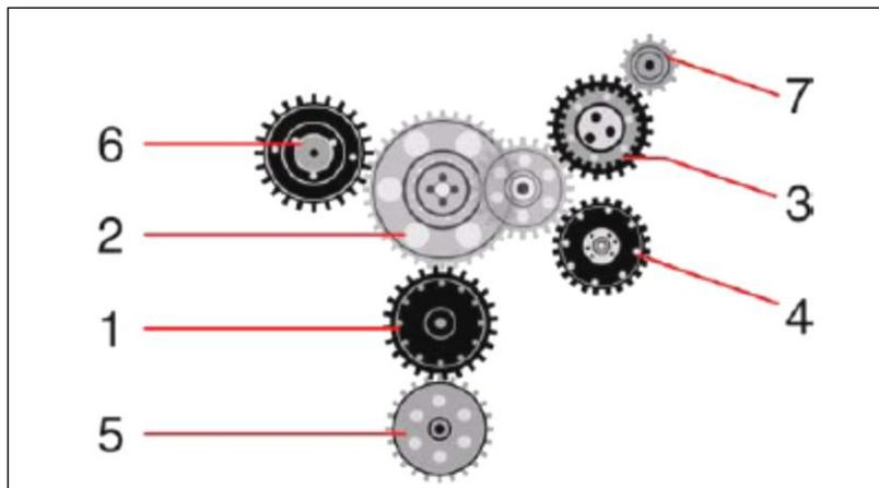
Gambar 3.173. Susunan gigi *timing*
