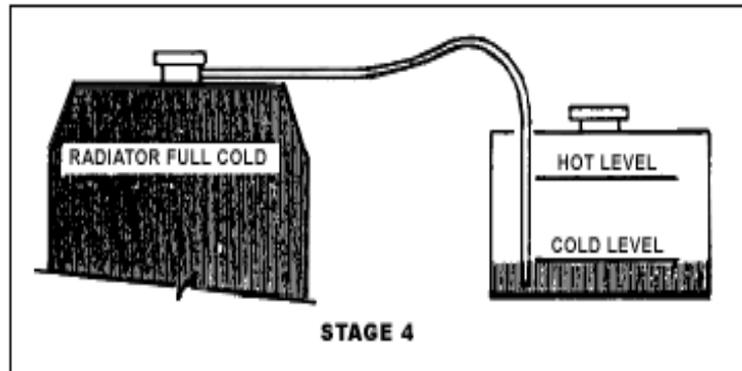
Gambar 2.72 *Stage 4* pengisian air pendingin dengan *reservoir*
