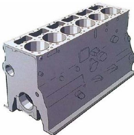
Gambar 3.49. Blok silinder
