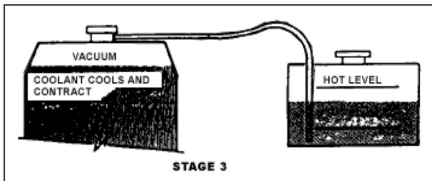
Gambar 2.71. Stage 3 pengisian air pendingin dengan reservoir
