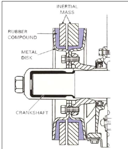
Gambar 3.107. *Flange* campuran karet *Rubber damper* terbuat dari *inner iron-alloy steel flange* yang memiliki dudukan dan *outer cast-iron weight assembly (inertial mass)*. *Flange* bagian dalam diikat dengan pemberat bagian luar menggunakan campuran karet (Gambar 3.107).
