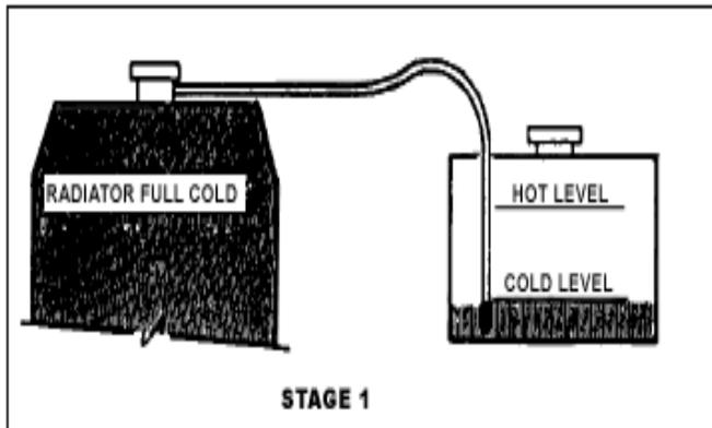
Gambar 2.69. Stage 1 pengisian air pendingin dengan reservoir
