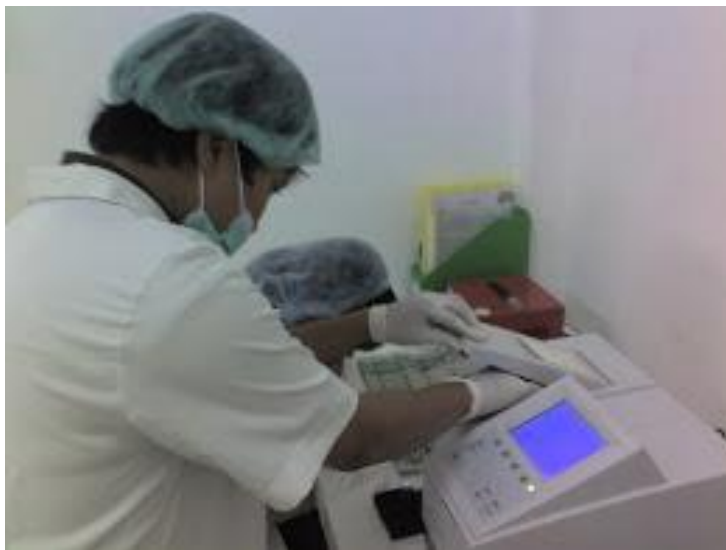
Gambar 33. Pengukuran kualitas air dengan menggunakan spektrofotometer
