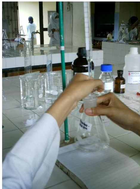
Gambar 32. Pengukuran kadar oksigen terlarut dengan cara titrasi
