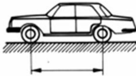
Gambar 6.4. Jarak sumbu roda (roda depan dengan roda belakang)
