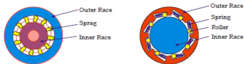
Gambar 4.11. Kopling satu arah tipe sprag dan tipe roller
