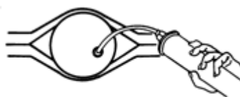
Gambar 4.68. Pengisian Oli pada Penggerak Aksel
