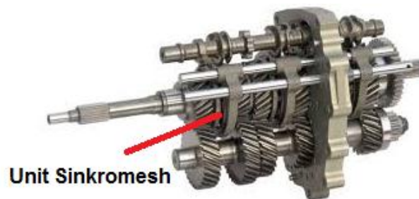
Gambar 4.29. Transmisi dengan sinkromesh
