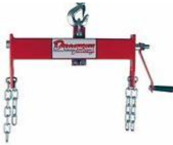
Gambar 3.16. Pemasangan alat khusus pengangkat engine
