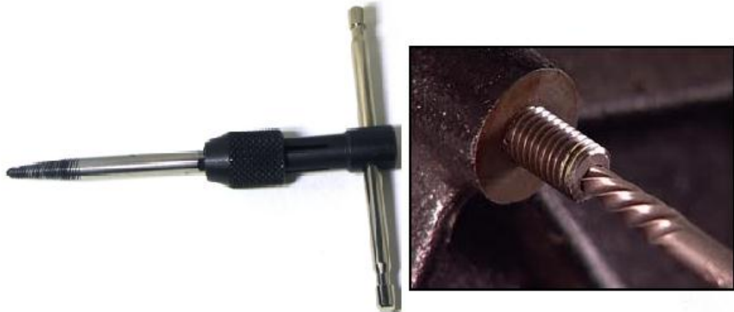
Gambar 4.24. Berikut cara penggunaan screw extractor yang benar.
