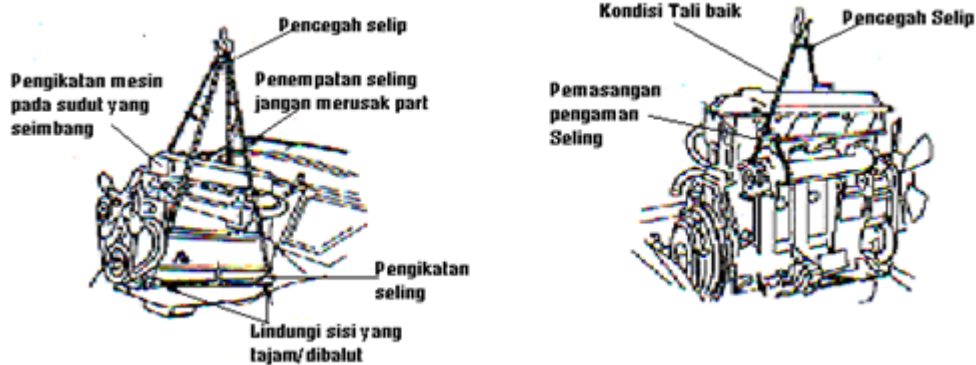
Gambar 3.14. Pemasangan tali atau seling pada engine.
