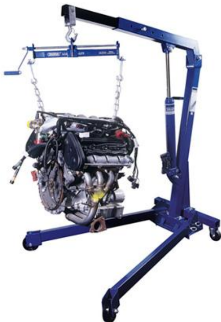
Gambar 3.18. Pengangkatan engine dengan Kran rantai
