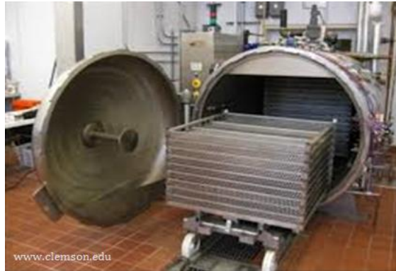
Gambar 53. Contoh proses sterilisasi dengan retort .
