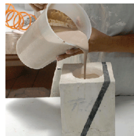
Sumber: Frans. H, Tanpa tahun Gambar 4.12 Penuangan adonan keramik
