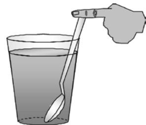
Gambar 7.10 Teh panas dapat merambatkan kalornya melalui sendok menuju ketangan dengan cara konduksi.
