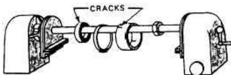
Gambar 5.5 Menggunakan konduktor pusat untuk circularly magnet ringlike bagian.
