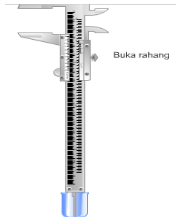
Gambar 3.23 Mengukur Kedalaman Benda
