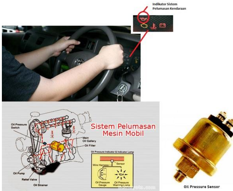
Gambar 2.2 Sistem pelumasan kendaraan dan indikator kerjanya
