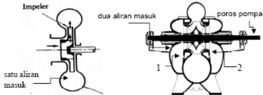
Gambar 3.56 Klasifikasi pompa berdasarkan jumlah aliran masuk
