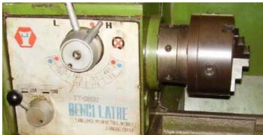
Gambar 5. 7. Spindel Mesin bubut
