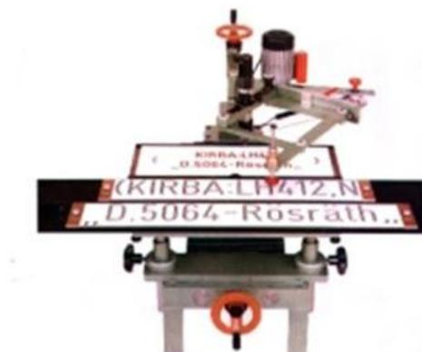
Gambar 4.22. Mesin Frais gravier
