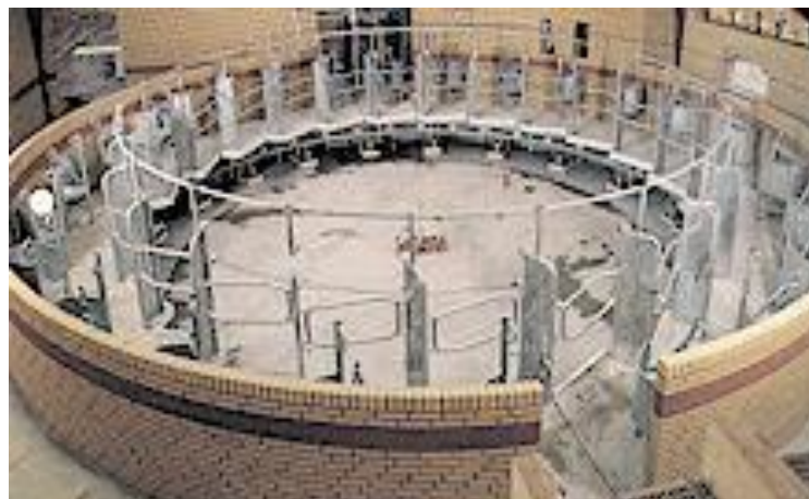
Gambar 21. Layout Mesin Perah Tipe Rotaryy Abreast
