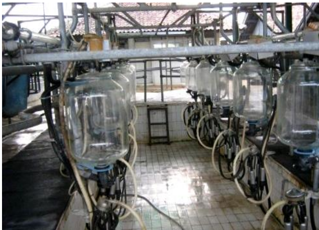
Gambar 19. Mesin Perah Tipe Herringbone dengan Tabung Individu.
