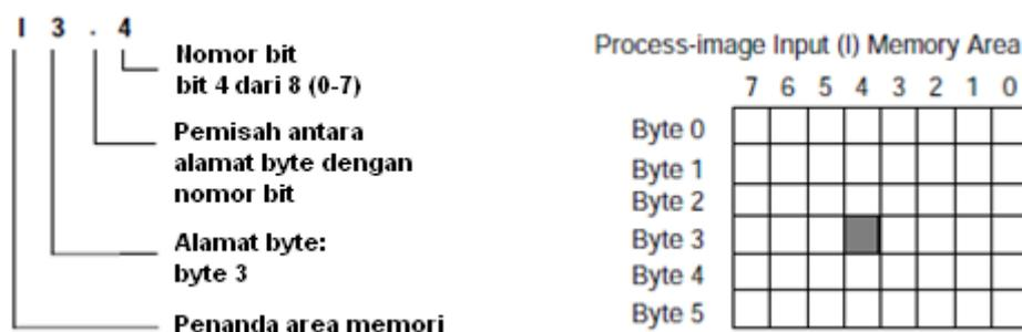
**Gambar 2. 38 Alamat byte, bit.**
