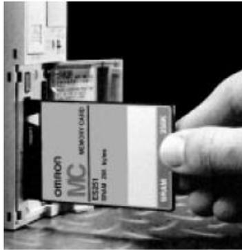
Gambar 2. 22 Kartu memori untuk pemrogram-mini.
