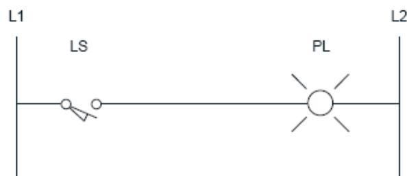
**Gambar 2. 61** Sebuah rangkaian rele dengan saklar batas yang digunakan untuk mengendalikan lampu.
