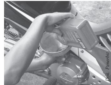
Gambar 15.11 Pemberian oli pada mesin dapat mengurangi gaya gesek
