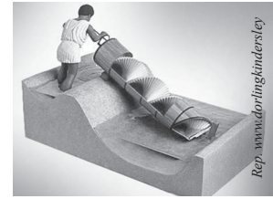
Gambar 18.15 Sekrup archimedes digunakan untuk menaikkan air
