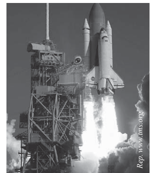
Gambar 16.7 Roket menggunakan prinsip hukum III Newton
