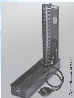
Gambar 6.8 Spigmomanometer digunakan untuk mengukur tekanan darah
