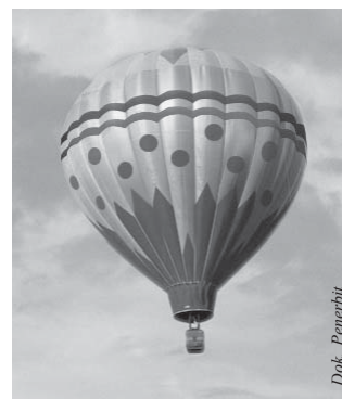
Gambar 19.13 Balon udara dapat melayang di udara menggunakan prinsip gaya Archimedes
