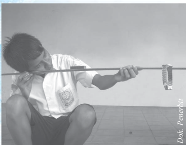
Gambar 21.2 Bunyi dapat merambat dengan medium zat padat
