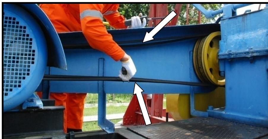
Gambar : 7.5 Mengecek Kekencangan V-belt
