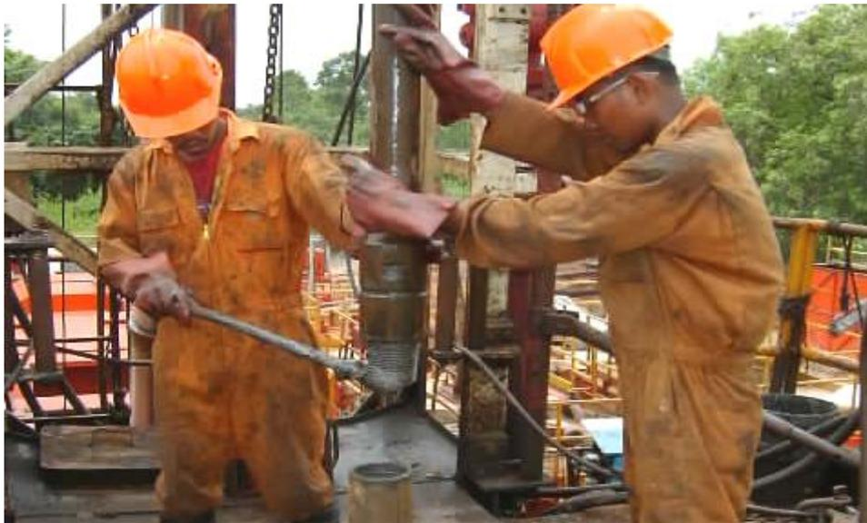
Gambar 5.4 Mengangkat Pipa dari Pipe Rack
