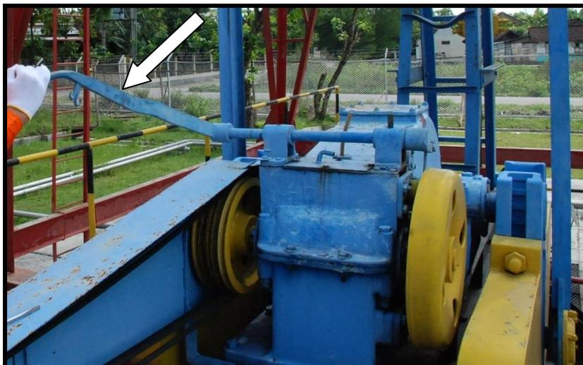
Gambar 7.14 Mengunci Hand brake
