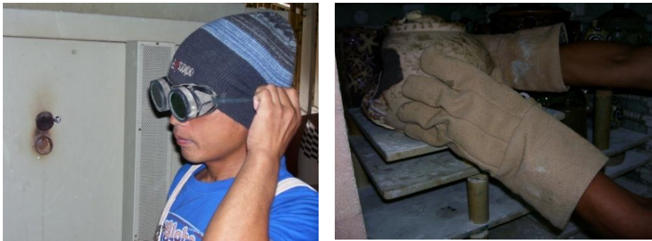
Gambar 45. Pemakaian kaca mata pelindung dan sarung tangan pada proses pembakaran
