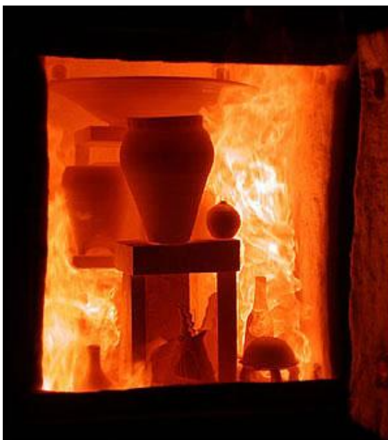
Gambar 35. Pembakaran dengan suasana oksidasi (Sumber: www.glazetechnology.com )
