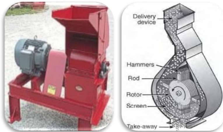
Gambar 39. Hammermill dan Penampang Bagian Dalamnya.
