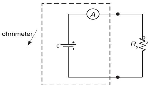
**Gambar 5.20.** Pengukuran hambatan listrik dengan menggunakan sebuah amperemeter
