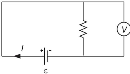
**Gambar 5.18.** Penggunaan voltmeter untuk mengukur beda potensial listrik
