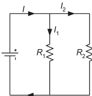
**Gambar 5.9.** Rangkaian paralel untuk membagi aliran arus listrik
