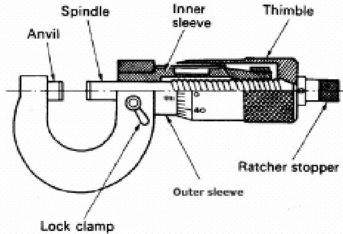
Gambar 5.9 Mikrometer dan bagiannya
