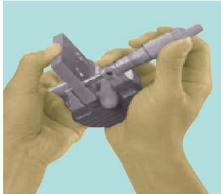
Gambar 5.12. Pemakaian mikrometer
