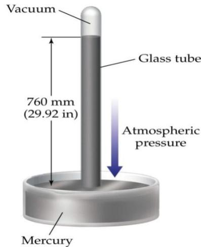
Gambar 5.18 Komponen Barometer
