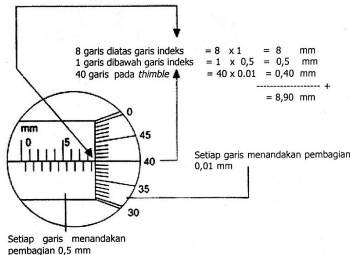
Gambar 5.11.Pembacaan mikrometer
