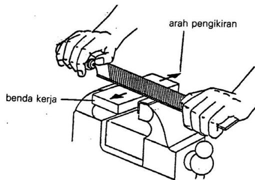
Gambar 6.63 Mengikir searah dengan panjang benda kerja
