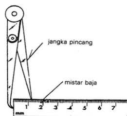
Gambar 6.32 Mengukur pembukaan kaki dengan mistar baja
