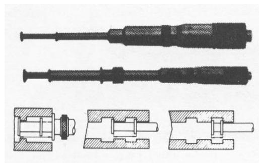
Gambar 5.15 Mikrometer alur dan cara pemakaiannya
