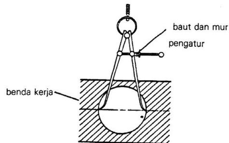
Gambar 6.26 Mengukur diameter dalam dengan jangka kaki
