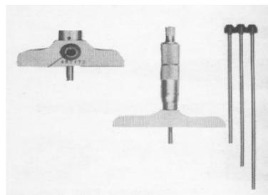
Gambar 5.14 Mikrometer kedalaman
