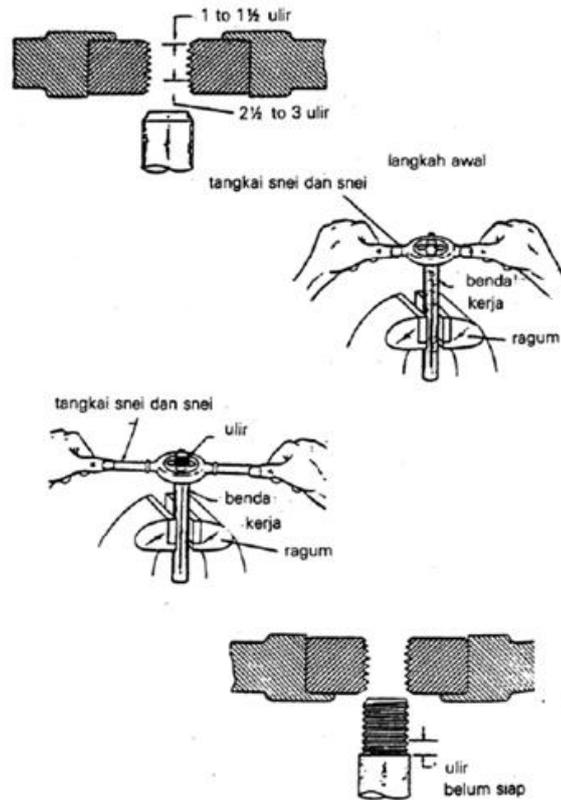
Gambar 6.98 langkah penguliran
