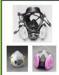
NAPR adalah pemurni udara dari [kontaminan](#) dan hanya dapat digunakan pada atmosfer yang mengandung oksigen minimal 19.5%. NAPR memurnikan udara yang terkontaminasi oleh partikel, aerosol, uap dan gas sebelum udara tersebut masuk kedalam sistem pernapasan.
