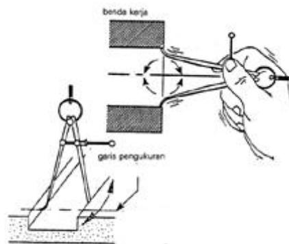
Gambar 6.27 Mengukur celah dengan jangka kaki
