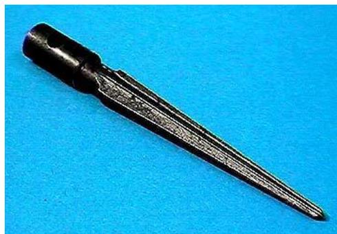
Gambar 6.99 Pemerluas lubang
