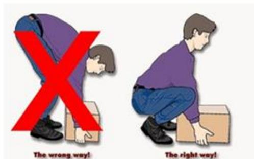
Gambar 3.15 Posisi Mengangkat benda
