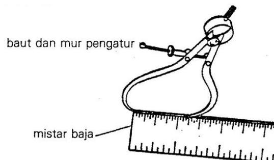
Gambar 6.30 Membaca ukuran dengan bantuan mistar baja
