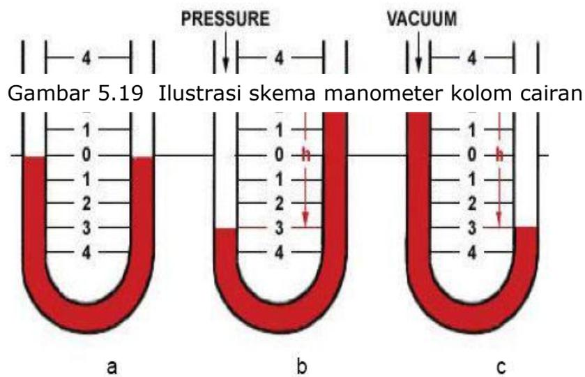
Gambar 5.19 Ilustrasi skema manometer kolom cairan
