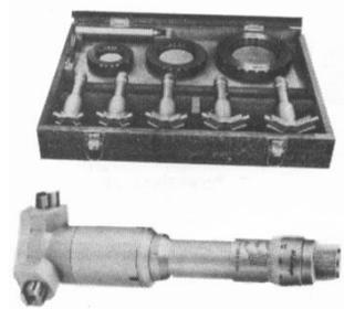
Gambar 5.13. Mikrometer tiga kaki
