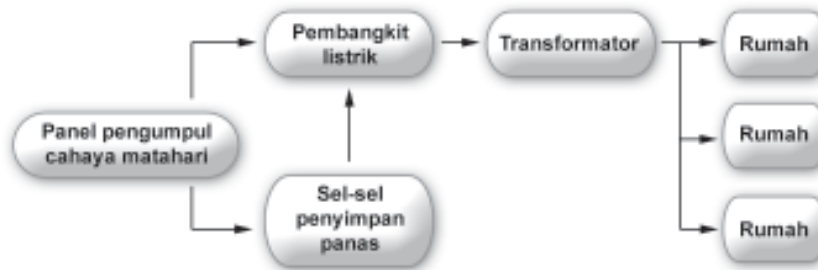
Gambar 12.3 Bagan Pembangkit Listrik Tenaga Surya
