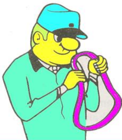
Pemeriksaan keretakan V Belt
