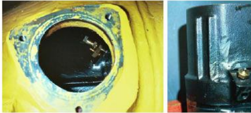
Gambar 6.14 - Track Roller Frame cover yang dilepas(kiri)
