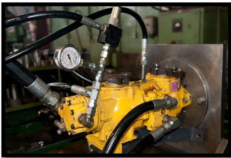
Gambar 3.13 Menguji pompa hidrolis
