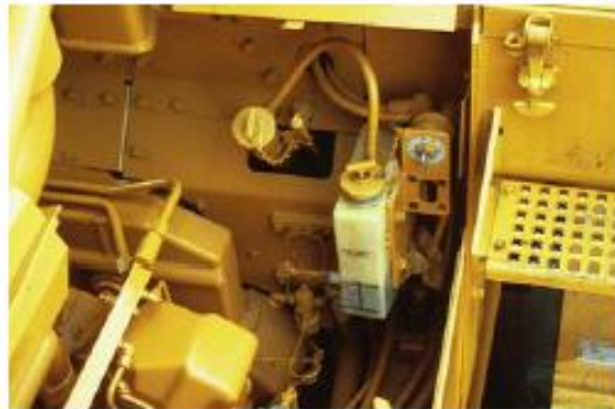
Gambar 6.13 – Ketinggian permukaan oli untuk Pivot Shaft Compartment
