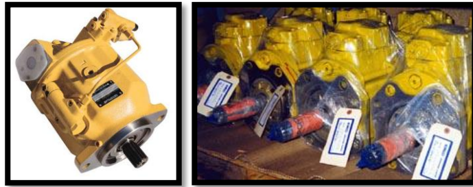
Gambar 3.5 Pompa baru (kiri) dan remanufaktur (kanan)
