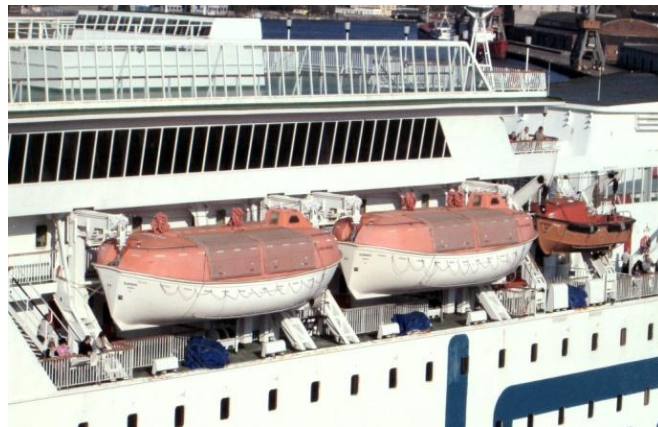
Gambar 53. Penempatan sekoci penolong di kapal
