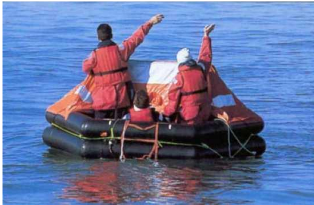
Gambar 67. Rakit penolong setelah dikembangkan di laut
