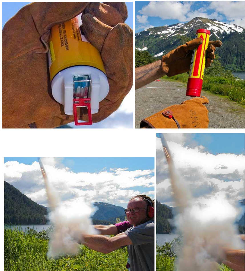
Gambar 79. Cara menggunakan cerawat parasut
