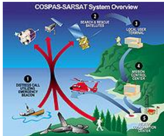
Gambar 91. Sistem kerja EPIRB
