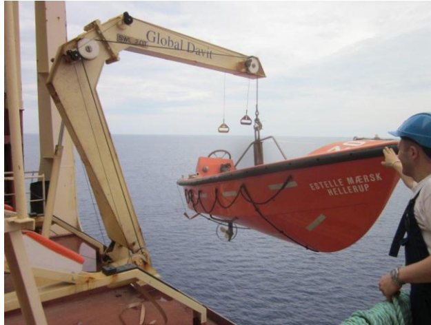
Gambar 28. Proses penurunan sekoci penyelamat menggunakan dewi-dewi untuk menolong orang yang jatuh ke laut
