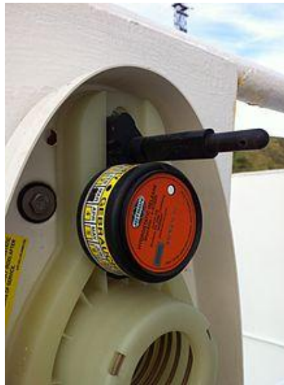
Gambar 92. Hydrostatic Release System pada EPIRB
