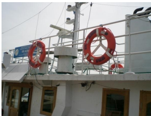
Gambar 39. Pelampung penolong ditempatkan di lokasi tertinggi di kapal atau di tempat umum
