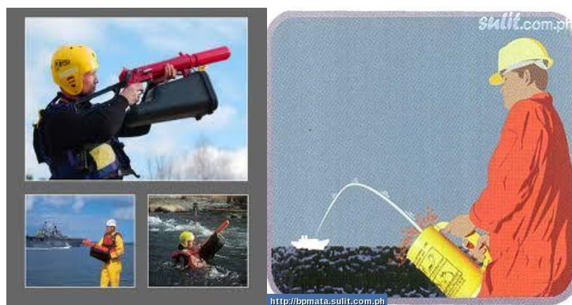
Gambar 89. Line throwing appliances digunakan untuk meluncurkan tali
