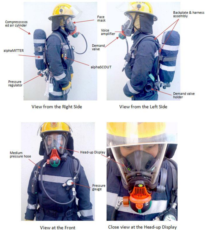
Gambar 99. Bagian dan cara menggunakan breathing apparatus
