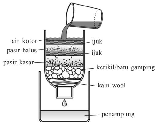
▲ Gambar 6.3 Model alat penjernih air.
