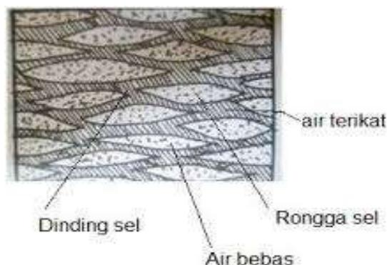
Gambar 3-7. Skema letak air bebas dan air terikat pada kayu
