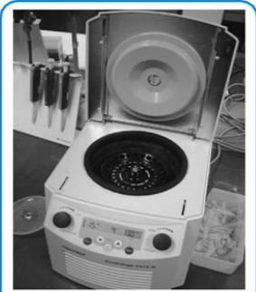
Gambar 8.4 Sentrifuge digunakan untuk memisahkan endapan dari larutannya
