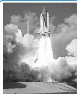
Gambar 3.6 Hidrogen cair digunakan untuk bahan bakar roket
