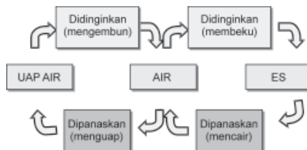
Gambar 6.6 Bagan perubahan wujud air Sumber: Ilustrasi Penerbit
