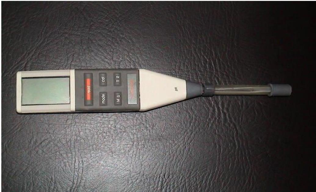
**Gambar 35. pH meter elektrik**
