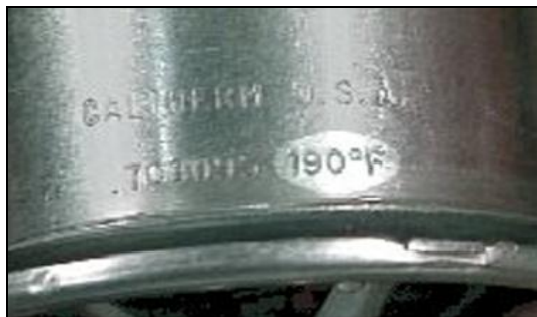
Gambar 23 Temperature pembukaan thermostat
