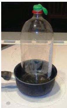
Gambar 7.6. Pemuaian gas di dalam botol plastik
