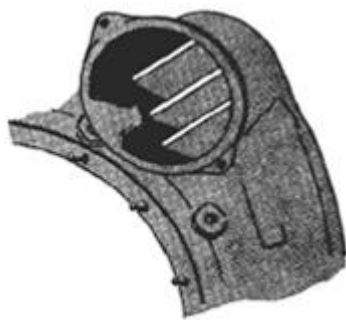
Gambar 31. Siku jalan keluar udara dengan sudu pembelok untuk mengurangi kehilangan tekanan.
