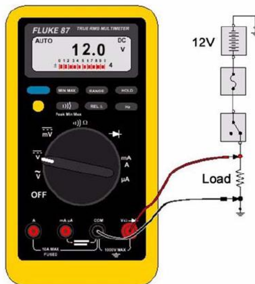
Gambar 2.13. Mengukur penurunan tegangan
