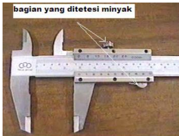
Gambar 4.1. Bagian jangka sorong yang ditetesi minyak
