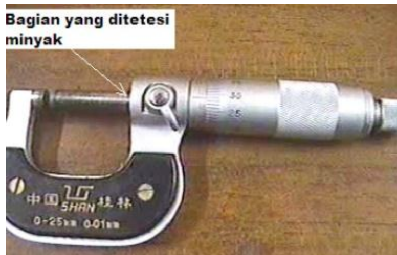
Gambar 4.4. Bagian mikrometer yang ditetesi minyak
