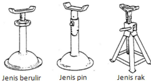
**Gambar 75. Ganjal untuk beban ringan hingga medium**
