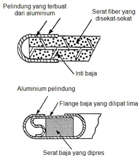
**Gambar 159. Konstruksi Gasket**
