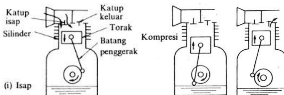
Gambar 16. Cara Kerja Kompresor Kerja Tunggal
