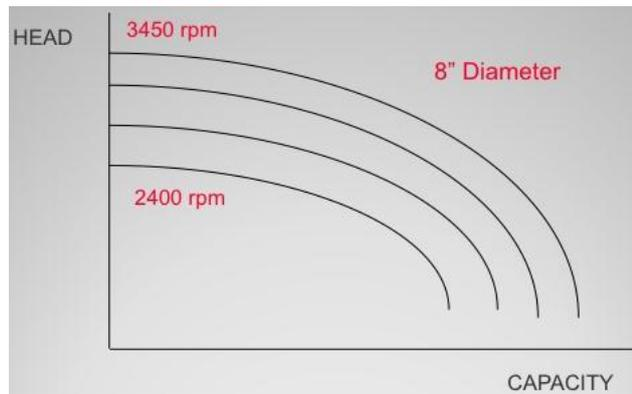
Gambar 13. Perbedaan Kapasitas Pompa Pada Impeler Yang Sama
