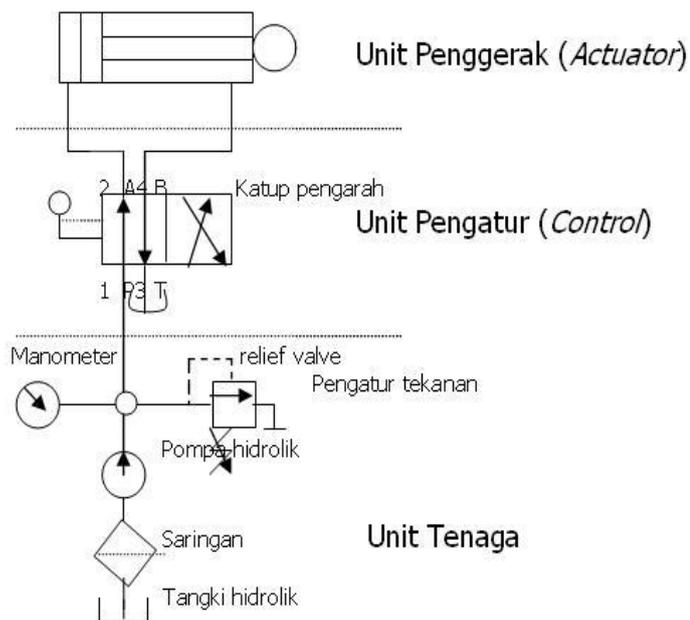
Gambar 10. Rangkaian Hidrolis Sederhana
