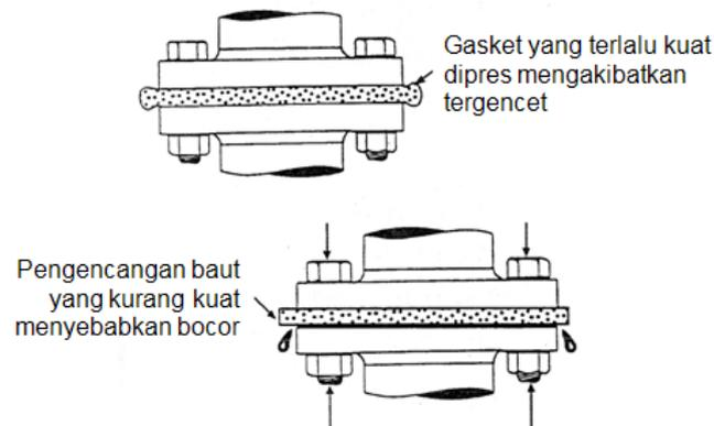
**Gambar 160. Pengencangan Baut**
