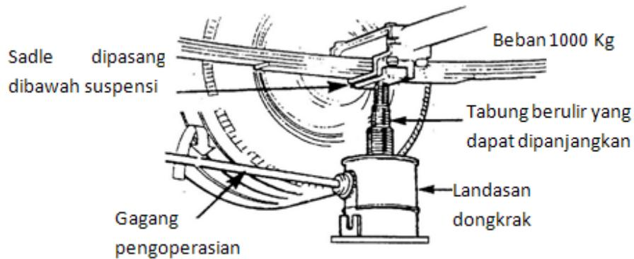
**Gambar 70. Dongkrak Mekanis**
