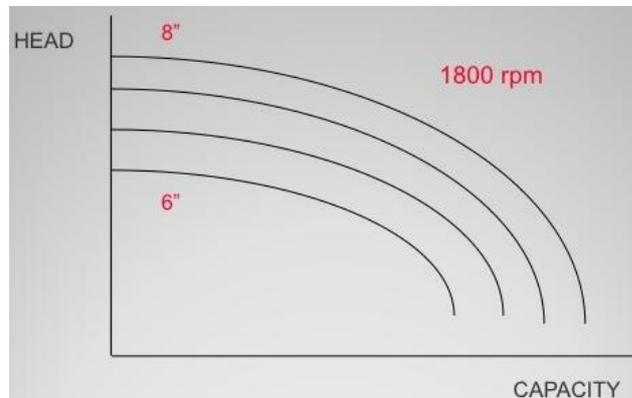
Gambar 12. Perbedaan Kapasitas Pompa Pada Putaran Yang Sama
