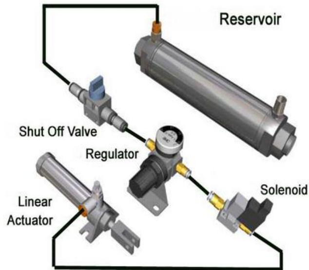
Gambar 3. Rangkaian Pneumatis
