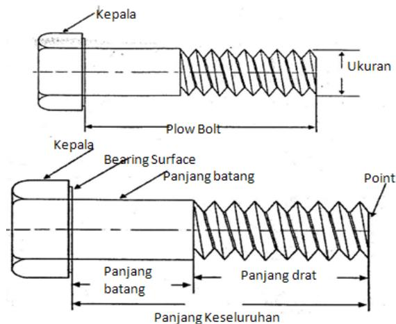
**Gambar 127. Bagian-bagian baut**
