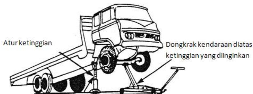
**Gambar 90. Titik Pendongkrakan**
